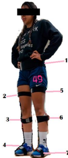
Figura 12. Colocación de sensores de Kinemov IBV. Monroy Mújica I.H. (Fotografía digital) Ciudad de México, Laboratorio de Ergonomía del Posgrado de Diseño Industrial, UNAM, 2022.
