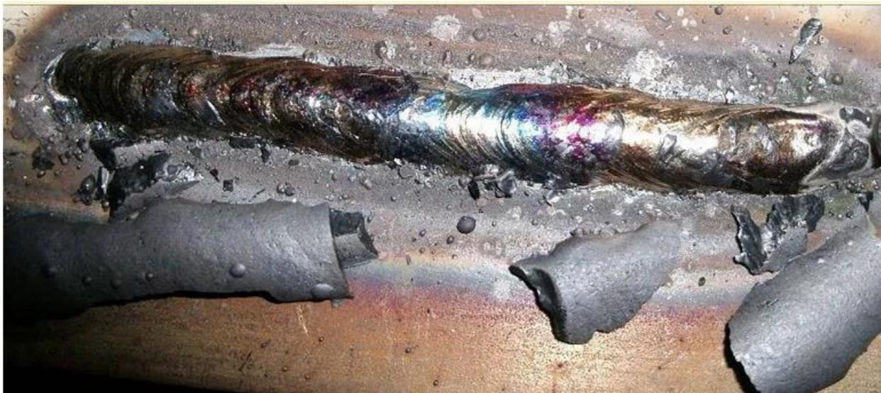
*Figura 1.3. Cordón de soldadura con escoria removida.<sup>[4]</sup>*
