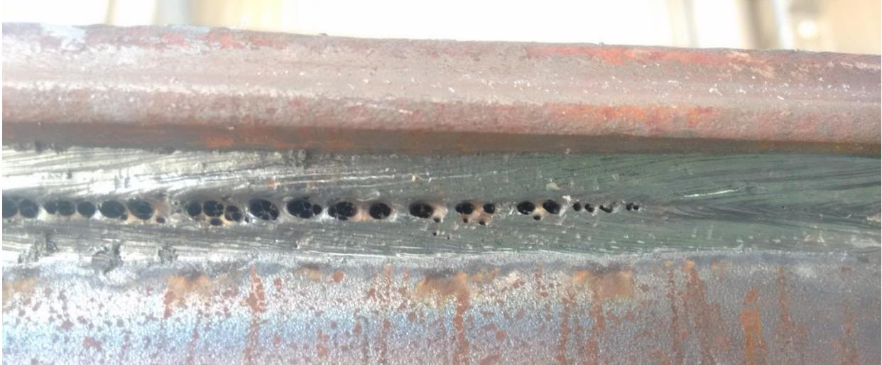
*Figura 1.2. Cordón de soldadura con alta porosidad.<sup>[3]</sup>*
