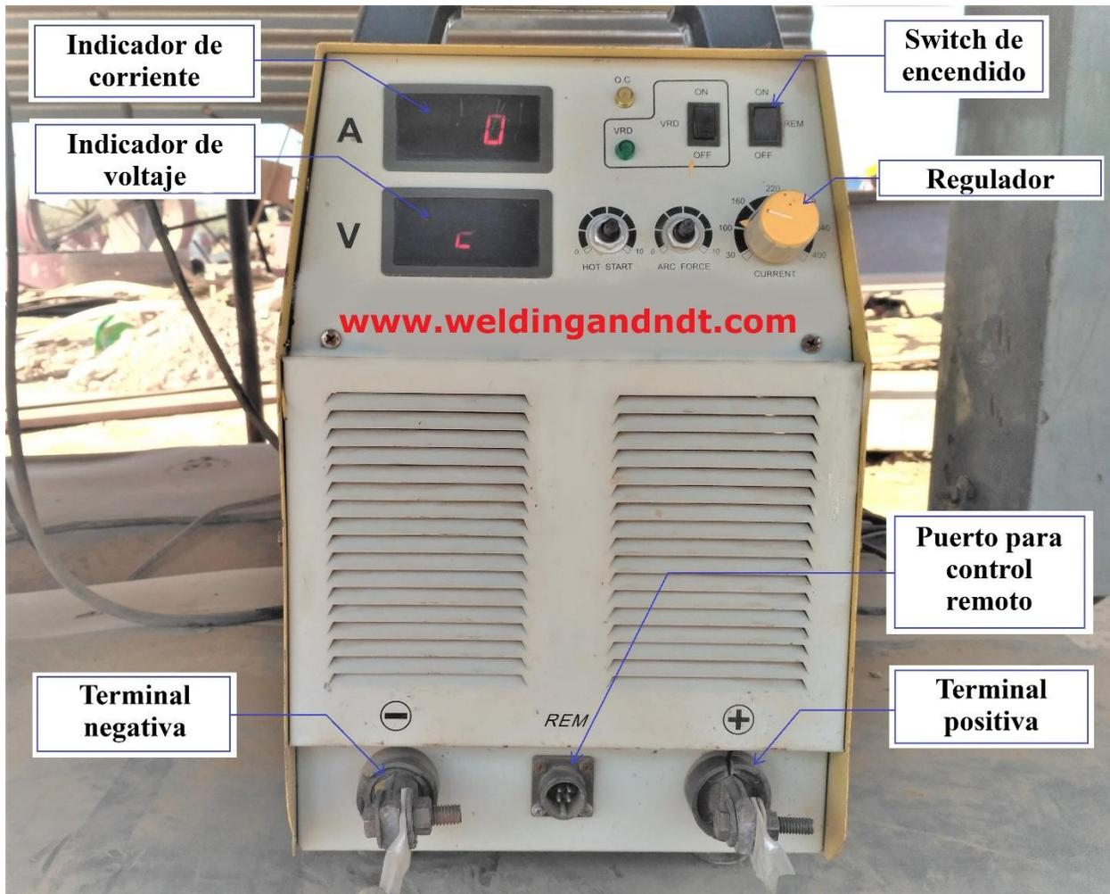
Figura 2.8. Máquina para soldar de CC con señalización de sus distintos componentes. <sup>[15]</sup>
