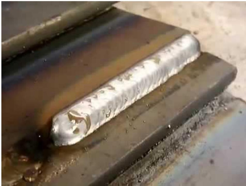
*Figura 1.1. Cordón de soldadura bien logrado según inspección visual.<sup>[1]</sup>*
