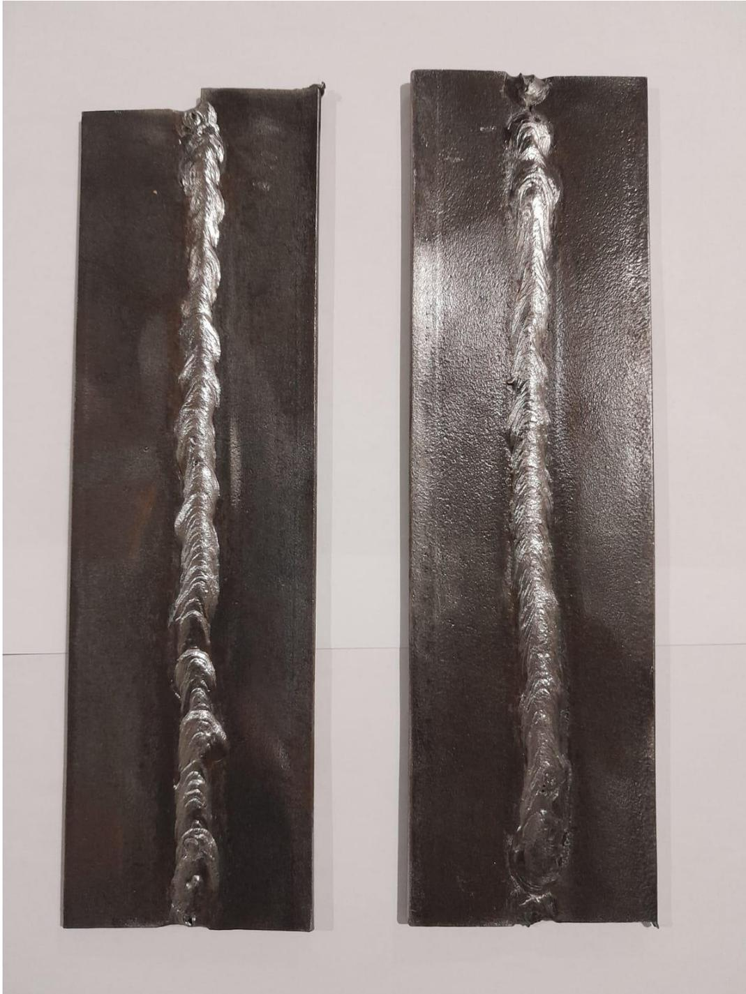
*Figura 3.2. Ejemplos de cordones de soldadura realizados en soleras de acero con electrodos revestidos E7018.*
