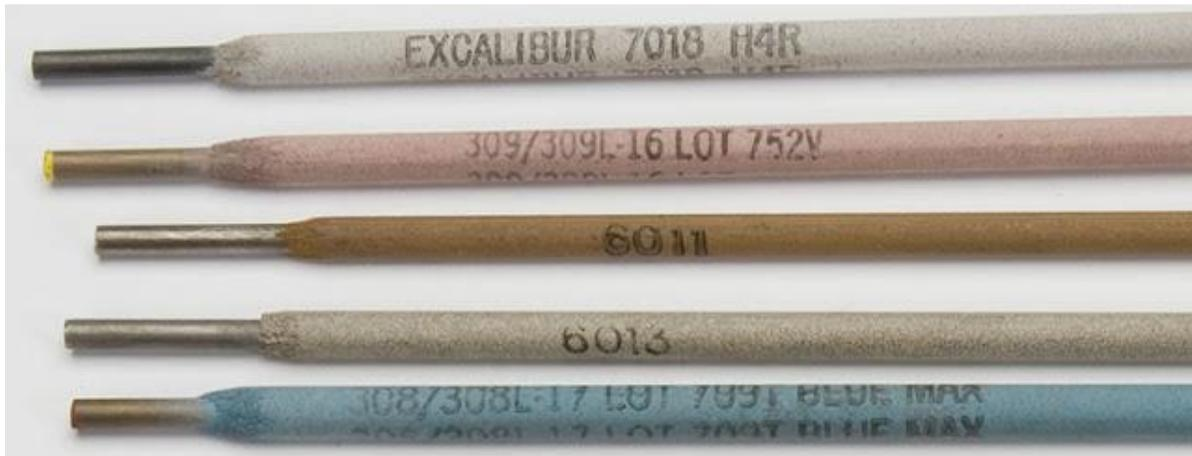
Figura 2.7. Electrodos revestidos y su clasificación. En orden de arriba hacia abajo: E7018, E309/309L-16, E6011, E6013, E308/308L-17<sup>[14]</sup>
