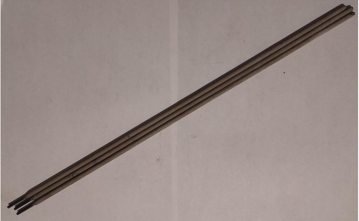
*Figura 3.1. Electrodos revestidos ProStar B10 E7018 seleccionados para determinación de masa promedio.*
