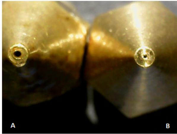
Figura 10. Boquillas de extrusión de 200  $\mu\text{m}$ . A) Boquilla de extrusión después de imprimir más de 50 muestras. B) Boquilla de extrusión antes de imprimir.
