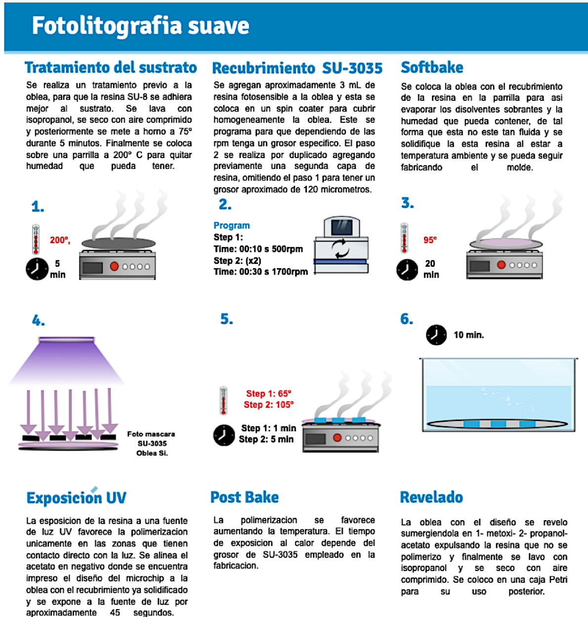
Figura 8. Esquema de la elaboración de moldes mediante litografía suave.
