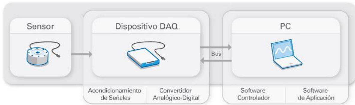
Figura 13. Esquematación de las partes de un sistema DAQ [Tomada https://www.stimx.org/service_adquisicion_datos.html Fecha de consulta: 3 junio 2022]
