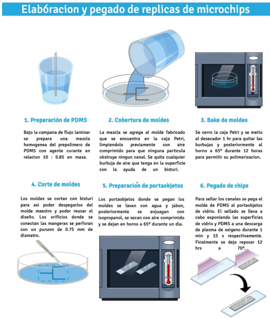
Figura 9. Elaboración de las réplicas de microchips con PDMS.
