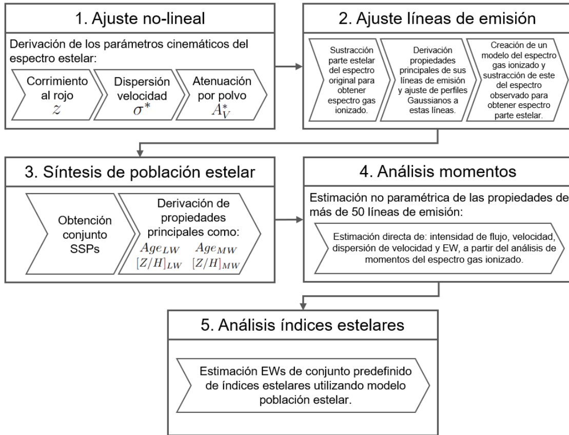
Figura 5.1.1: Diagrama de flujo en el que se muestran los pasos que siguen pyFIT3D y pyPipe3D para realizar el análisis espectral descrito por Sánchez et al. (2016b) y Lacerda et al. (2022).
