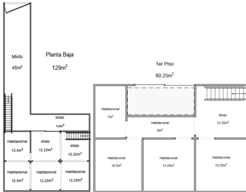
Figura 20. Usos mixtos y habitacionales de las instalaciones (planta baja y 1er piso)
