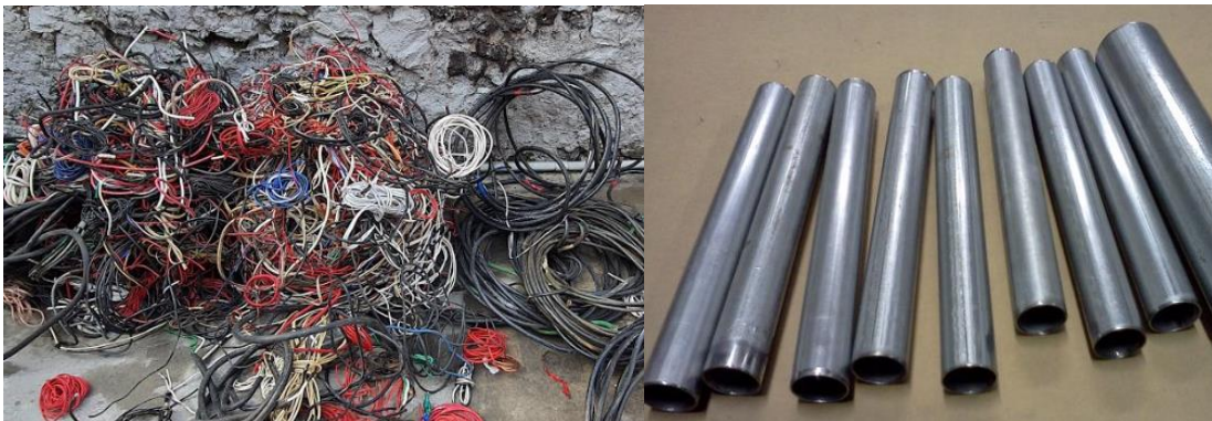
Figura 32. Residuos de cable de cobre y tubos galvanizados
