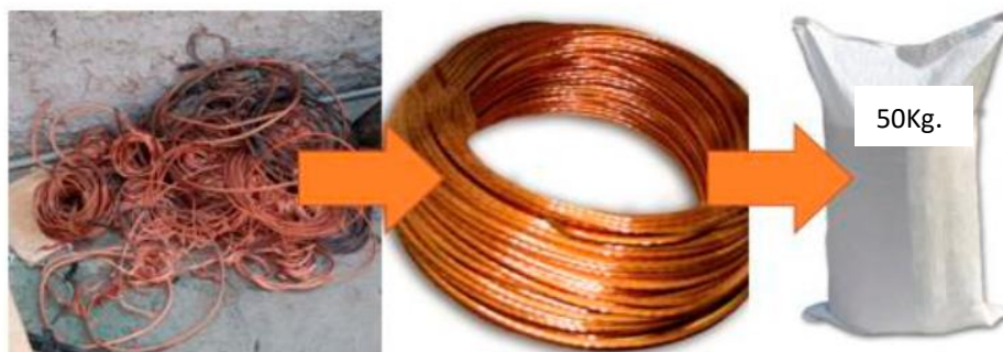
Figura 44. Empaquetado de cable sin recubrimiento
