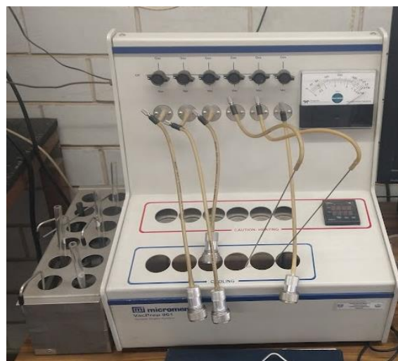
Figura 17. Sistema de vacío y desgasificación.
