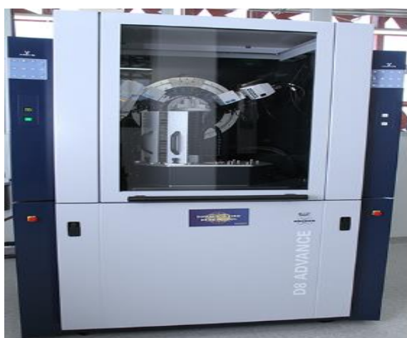
Figura 15. Equipo D8 ADVANCE para análisis de DRX
