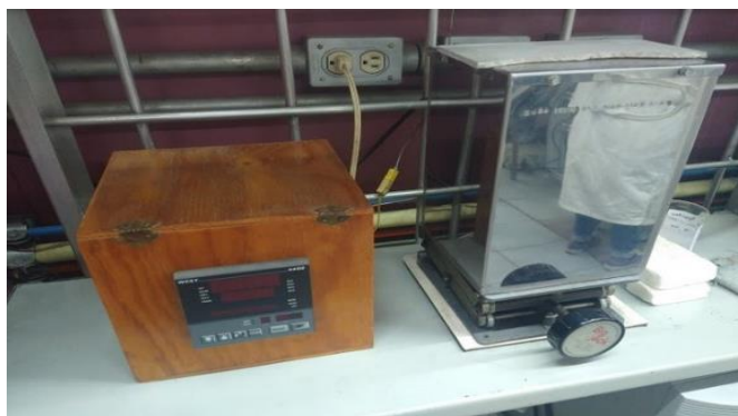
Figura 12. Controlador de temperatura y horno utilizados en el proceso de oxidación- reducción
