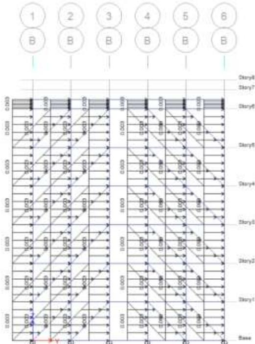
Imagen 26.- Aplicación de fuerzas de viento en elementos barra (corte).
