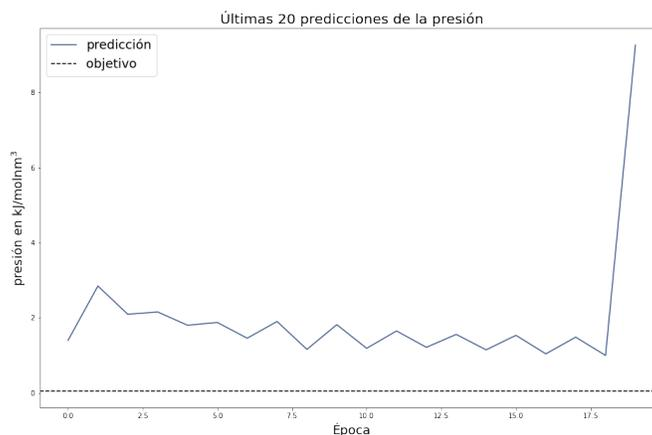
**Figura 21:** Últimas 20 predicciones hechas a partir del potencial inferido por el algoritmo DiffTRe. El resultado final se encuentra a dos órdenes de magnitud de distancia del valor real de la presión.
