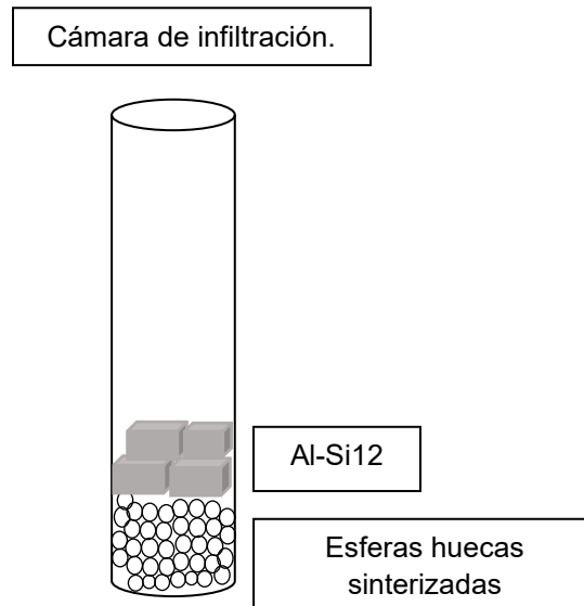
Figura 34. Esquema de acomodo de elementos para fabricación de espuma dentro de la cámara de infiltración.
