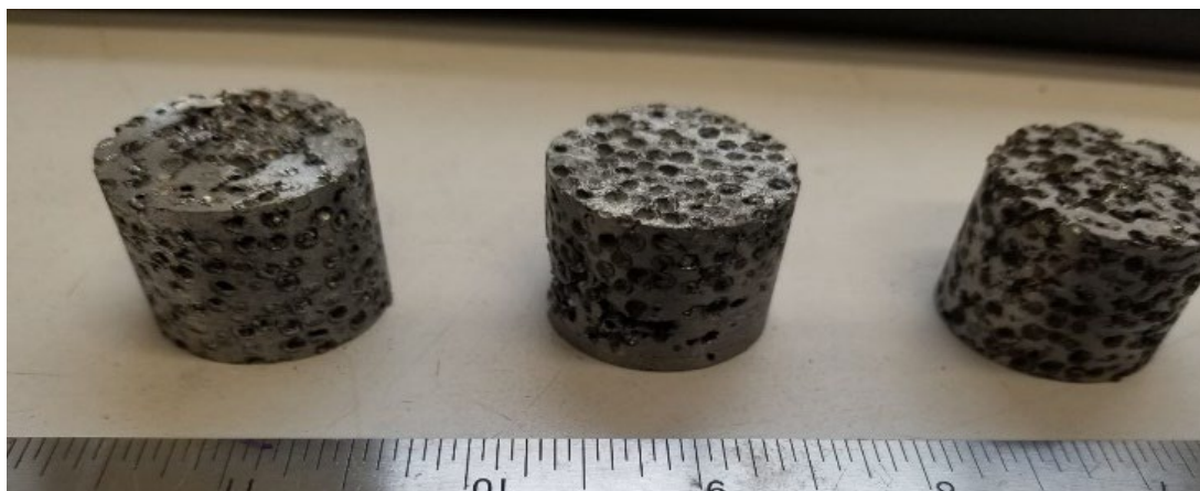
Figura 36. Muestras de espumas sintácticas preparadas para ensayo de compresión.
