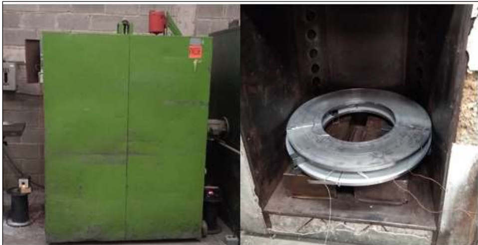
Figura 4.3. Configuración de carga en horno.
