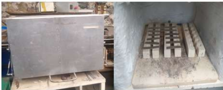
Figura 4.2. Configuración de horno de pruebas de temperatura.
