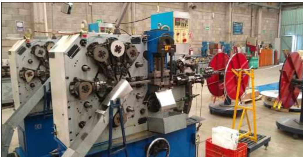
Figura 2.14. Equipo de fabricación de clip ménsula.
