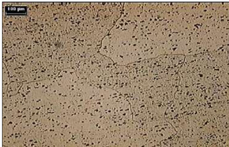
Figura 2.2. Microestructura de una aleación 6061 T6 50x. [10]
