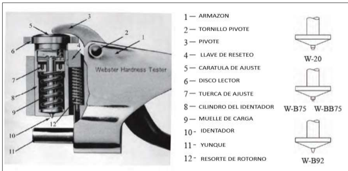
Figura 2.8. Partes del durómetro, estructura y tipos de indentador [28]
