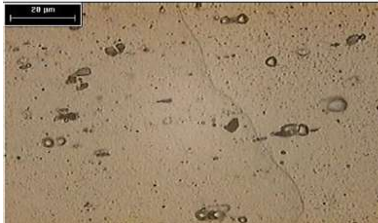
Figura 2.3. Microestructura de una aleación 6061 H0, 50x. [10]
