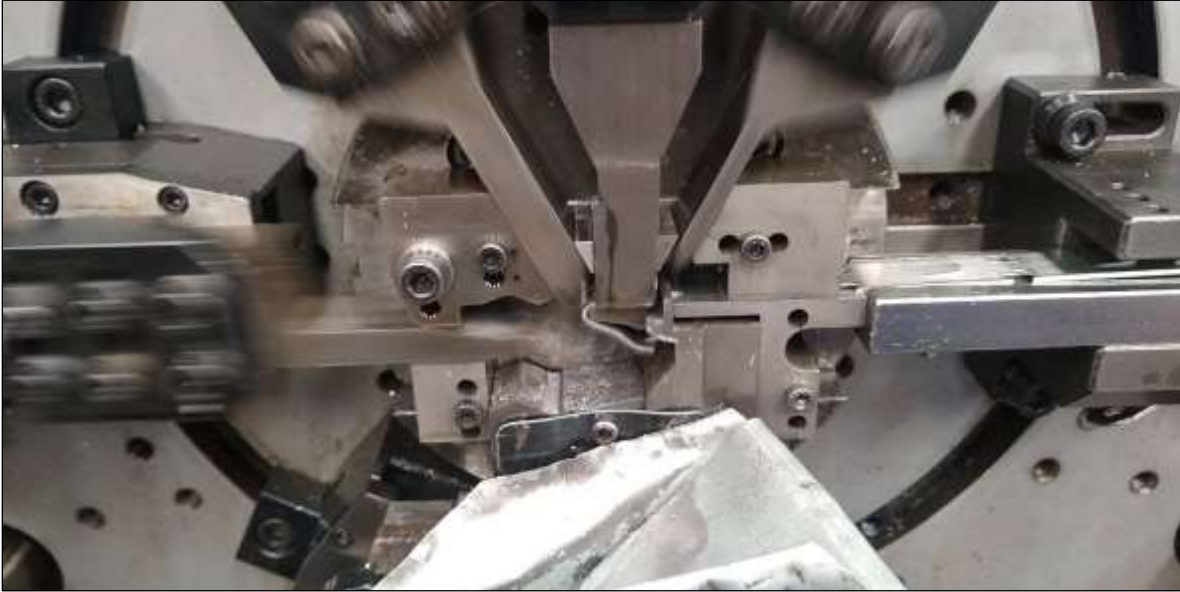
Figura 2.15. Conformación de clip ménsula cremallera.
