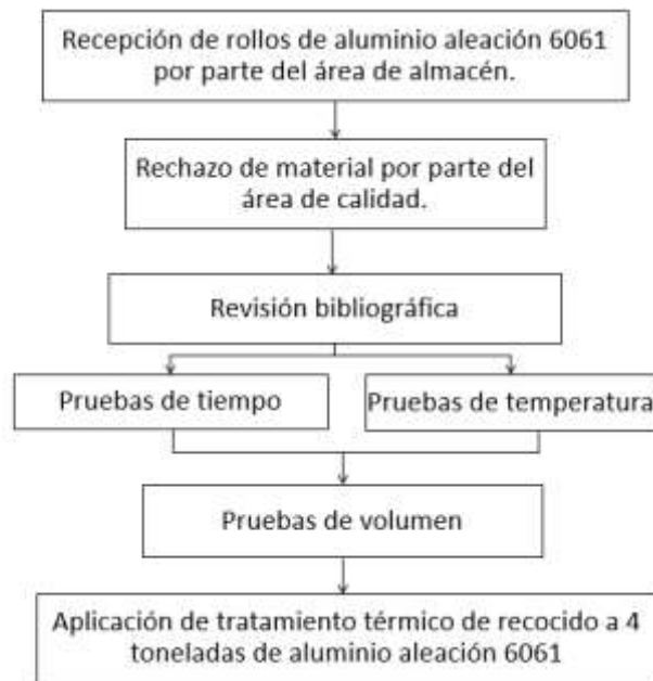
Figura 4.1. Diagrama de flujo procedimiento experimental.
