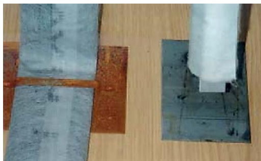
Anclaje de drenes verticales prefabricados tipo banda y cilíndrico (Menard, 2019)
