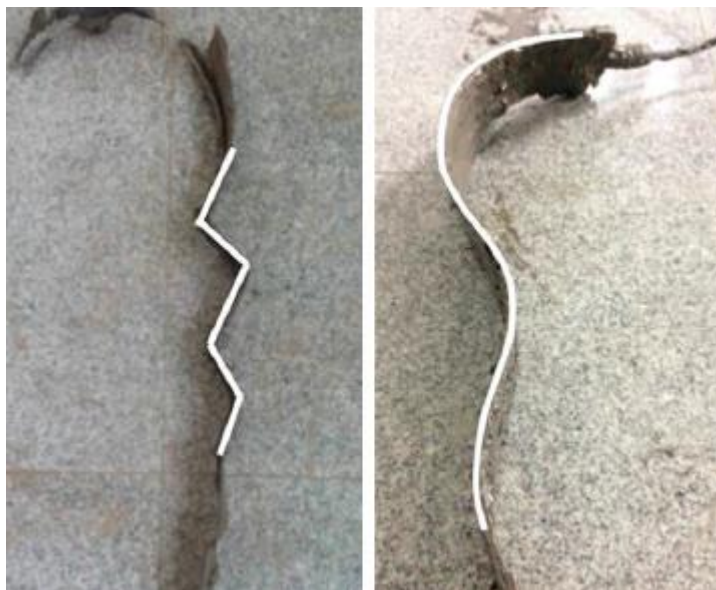
Figura 2.18 Dren deformado después de someter el suelo a consolidación de un PVDs convencional (izquierda) y de un dren con deformación tipo S (derecha) (Cai et al., 2017).
