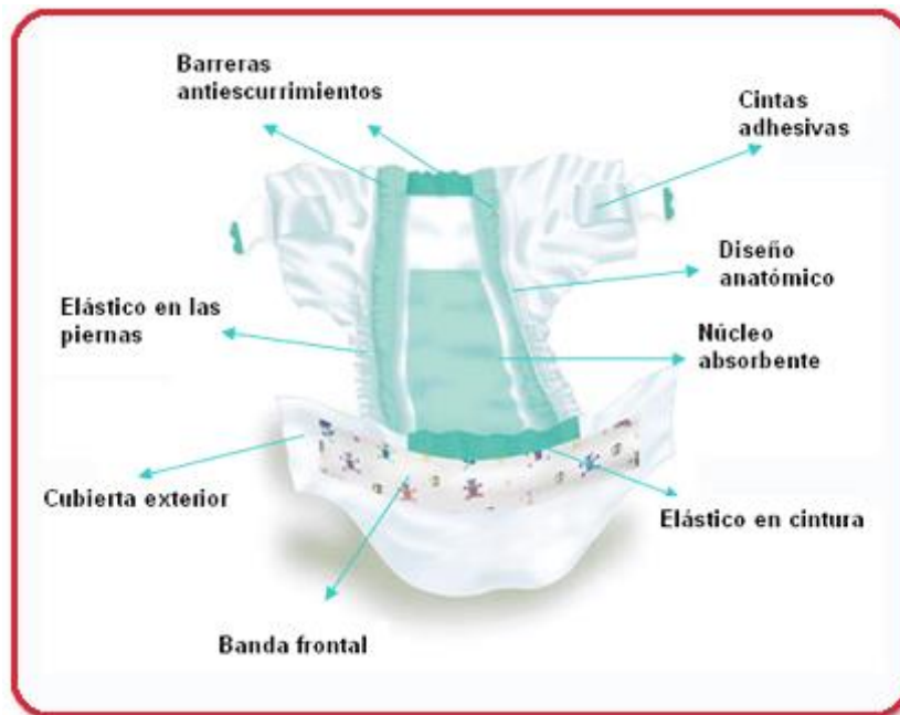
Figura 3.1: Ubicación de los componentes encontrados en un pañal desechable (Brito, 2007)
