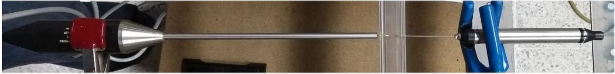
Figura 2-8.- Micrófonos de sonda, izquierda micrófono 4170 y a la derecha el micrófono 4182.
