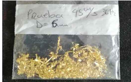
Figura 3.3 Polvo metálico y trozos de cinta irregular que resultaron a velocidad de giro de 45 m/s.
