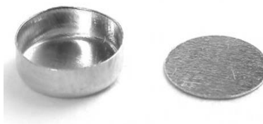
Figura 2.8 Crisol utilizado para realizar análisis térmicos (DSC).
