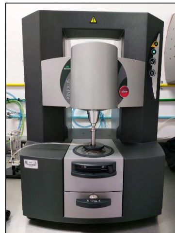
p) Pruebas dinámicas en DSR para un rango de frecuencias y temperaturas dentro del LVR.
