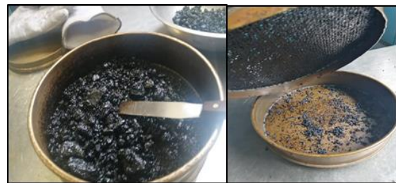
b) Tamizado en caliente de la mezcla asfáltica sobre la malla N°8 (2.36 mm). Recuperación de FAM real dentro de la mezcla.
