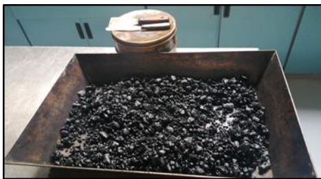
a) Elaboración de mezcla asfáltica para el 4% de vacíos al contenido óptimo de cemento asfáltico. (Curada a la T° de compactación)
