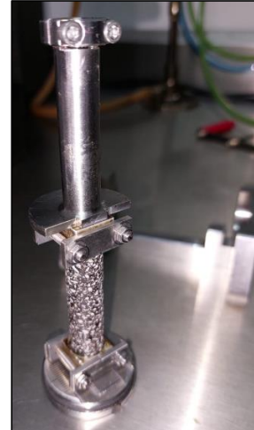
n) Núcleo de FAM en posición para ser colocado en reómetro de corte dinámico, (DSR, por sus siglas en inglés)
