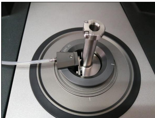
o) Instalación del dispositivo de torsión en DSR junto con celda de control de temperatura.
