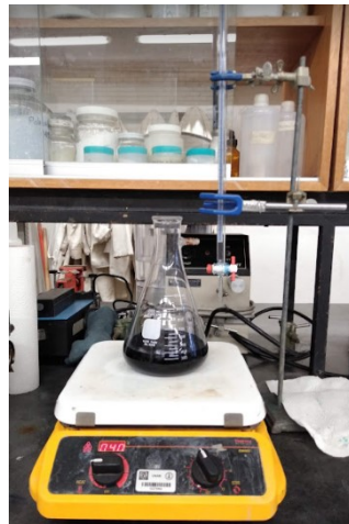
Figura 1. Titulación con azul de metileno.
