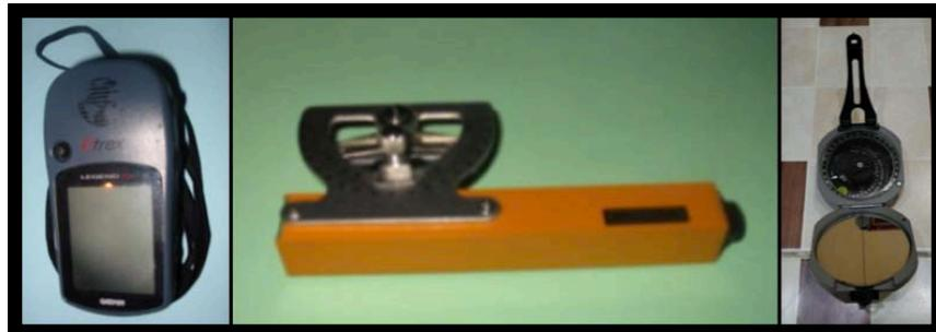
Figura 14. En esta imagen se muestra parte del equipo utilizado en el levantamiento de los perfiles de playa del área de estudio.
