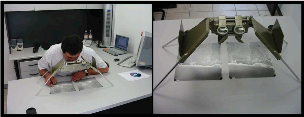
Figura 11. El trabajo de gabinete relacionado con la utilización de fotografías aéreas (pares fotográficos) del área de estudio y la utilización de un estereoscopio de espejos marca Wild.
