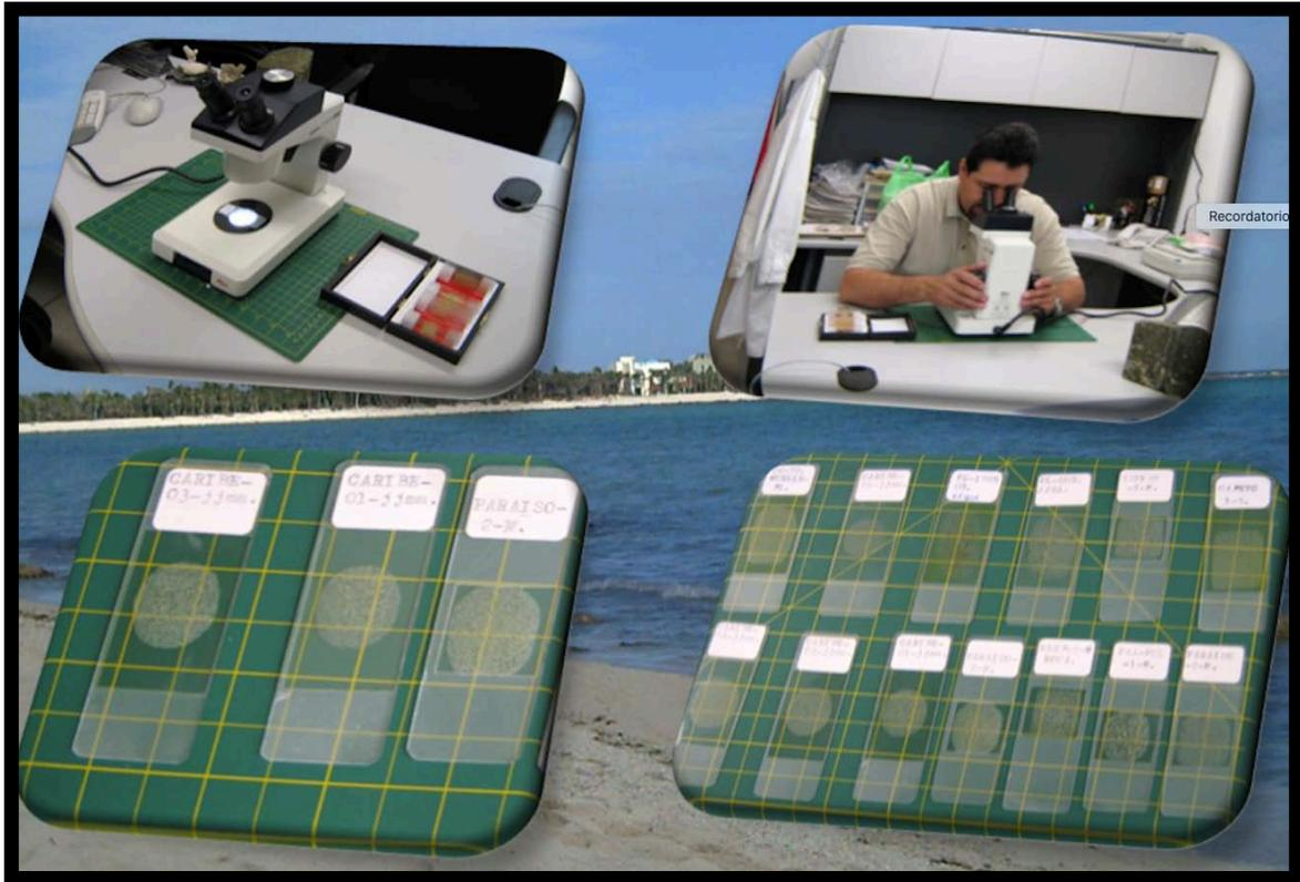
Figura 25. Las láminas delgadas utilizadas en los estudios petrográficos y el microscopio estereoscópico.
