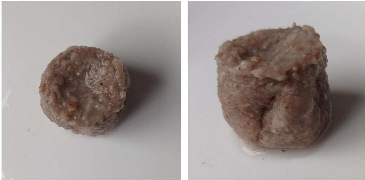
Figura 65: Prueba S1 de solubilidad, solo agua. Después de 7 días.
