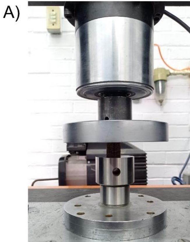
Figura 37: Prueba de Compresión paralela a la superficie, comparación visual entre el inicio de la prueba (A) y el término de ésta (B).
