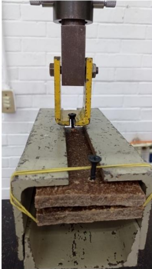
Figura 33: Prueba de retiro directo del tornillo, comparación visual entre el inicio de la prueba (A) y el término de ésta (B).
