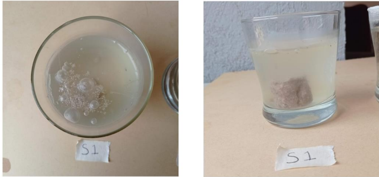
Figura 64: Prueba S1 de solubilidad, solo agua.
