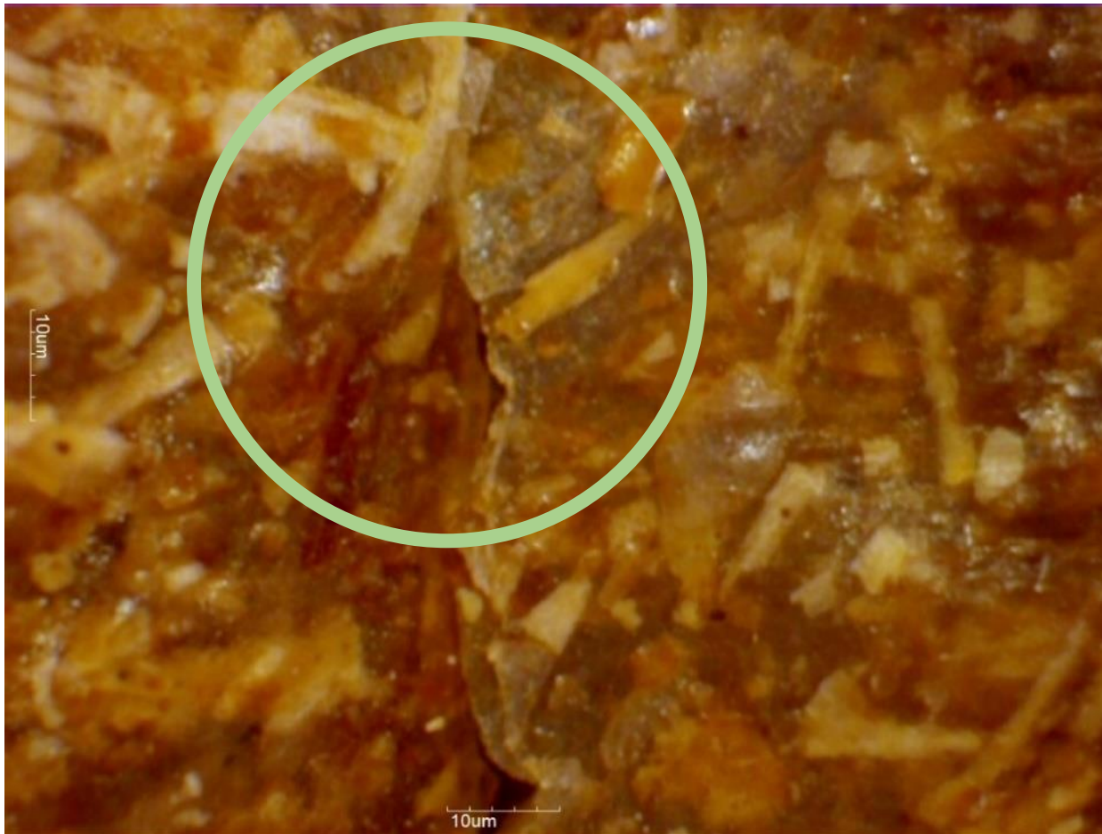
Figura 71: Apreciación de burbuja en el material
