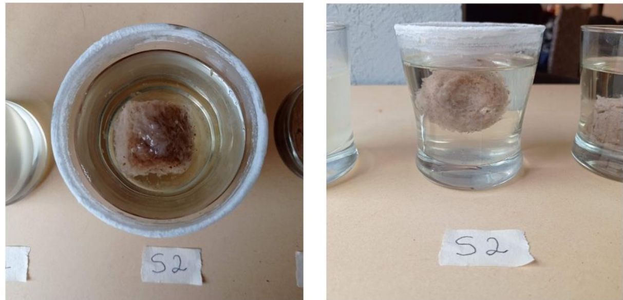
Figura 66: Prueba de solubilidad, agua con 50gr de sal.
