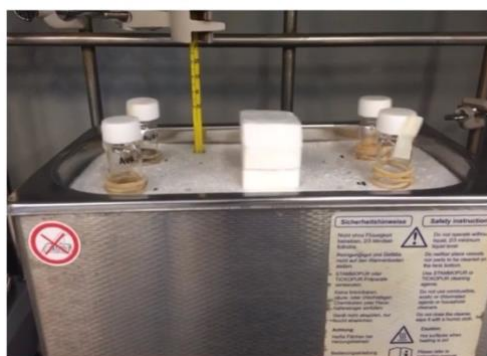
Figura 9. Montaje del equipo para la síntesis de la series B y C con el ultrasonido y el motor.
