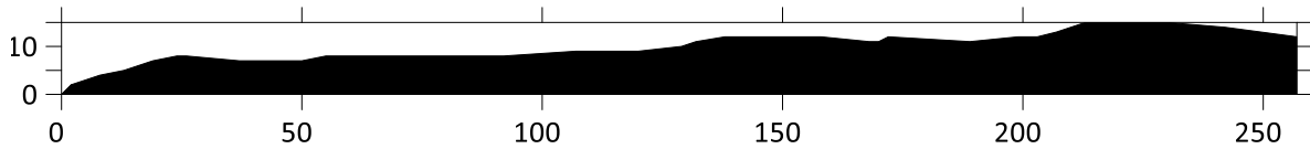
Ilustración 81 Perfil topográfico del transecto 6, medido con GPS en modo RTK. Área = 2586m 2 .
