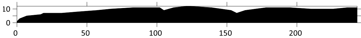
Ilustración 73 Perfil topográfico del transecto 4, medido con GPS en modo RTK. Área = 2324m 2 .
