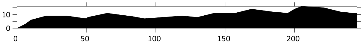
Ilustración 69 Perfil topográfico del transecto 3, medido con GPS en modo RTK. Área = 2488.50m 2 .
