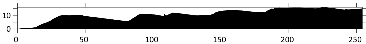
Ilustración 92 Perfil topográfico del transecto 8, obtenido mediante el DEM del vuelo a 60m de distancia. Área = 2745.59m 2 .
