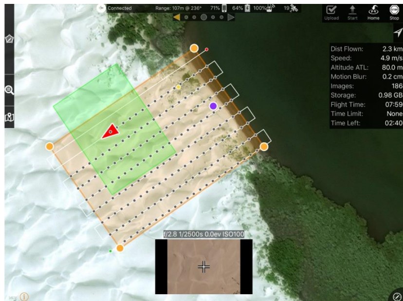
Ilustración 11 Captura de pantalla del plan de vuelo de este estudio a 80m de altura
