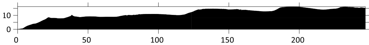
Ilustración 87 Perfil topográfico del transecto 7, obtenido mediante el DEM del vuelo a 50m de distancia. Área = 2851.90m 2 .
