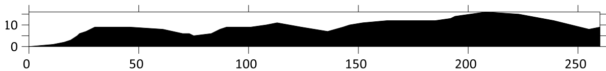
Ilustración 89 Perfil topográfico del transecto 8, medido con GPS en modo RTK. Área = 2488m 2 .
