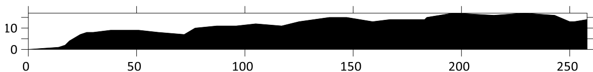
Ilustración 93 Perfil topográfico del transecto 9, medido con GPS en modo RTK. Área = 3034m 2 .
