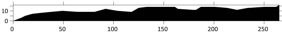
Ilustración 85 Perfil topográfico del transecto 7, medido con GPS en modo RTK. Área = 2925m 2 .
