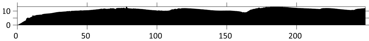
Ilustración 80 Perfil topográfico del transecto 5, obtenido mediante el DEM del vuelo a 60m de distancia. Área = 2638.91m 2 .
