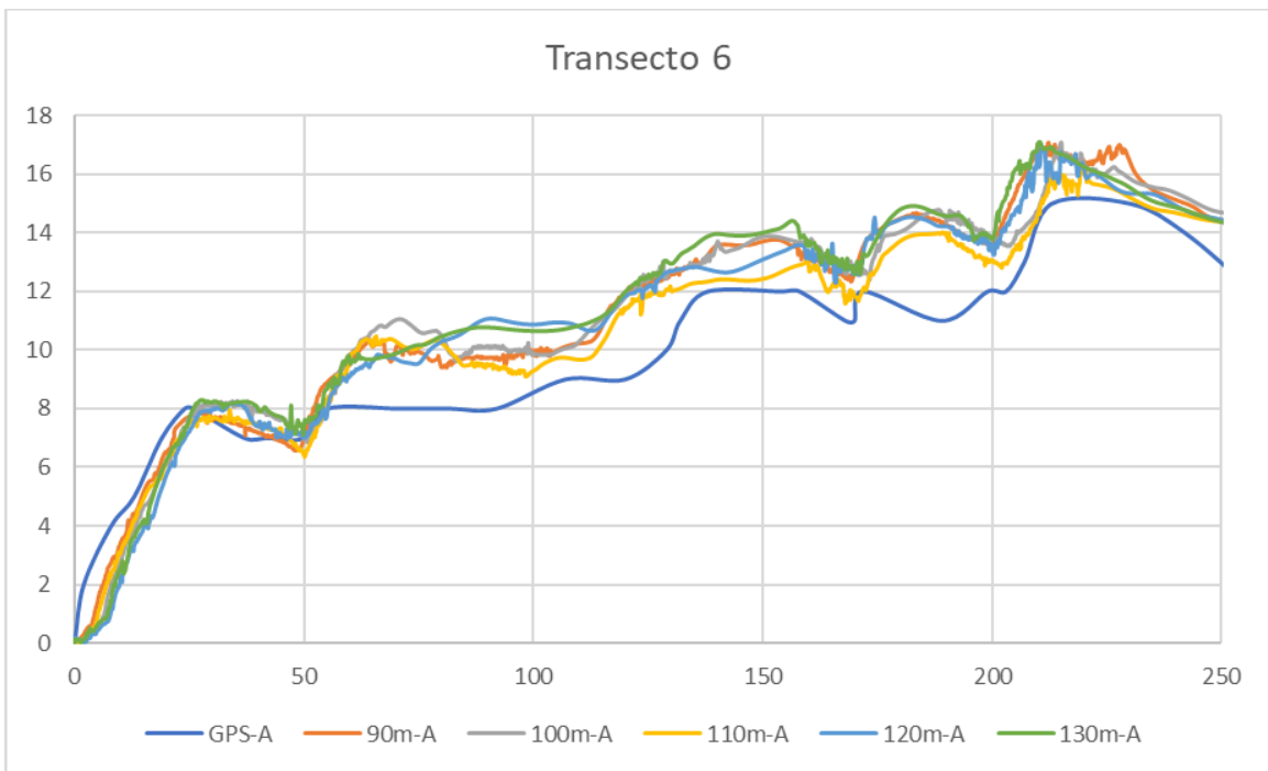
Ilustración 60 Comparación de los perfiles topográficos de la superficie natural con los modelos digitales de superficie, en este caso se observa que los perfiles generados con la información de los vuelos a una altura mayor de 90m presentan variaciones a la hora de describir la superficie.
