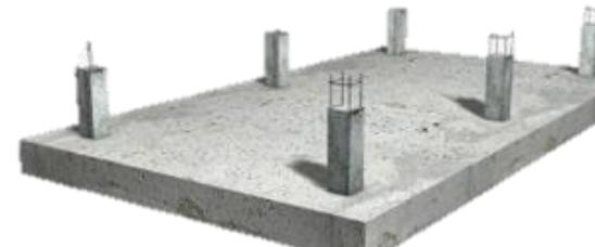
Imagen 6.4-Losa de Cimentación
