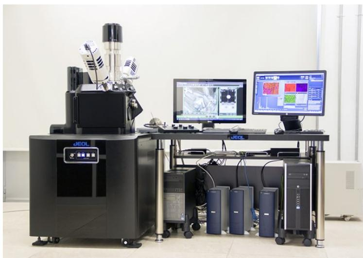
Figura 12. Equipo JEOL JSM-IT300 utilizado para realizar análisis EDS.
