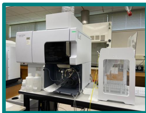
Figura 25. Equipo ICP, Agilent 5100/5110 ICP-OES, NADP
