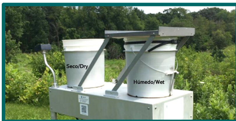
Figura 14. Sistema automático de muestreo de depósito atmosférico REDDA
