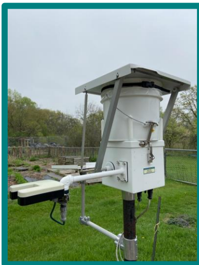
Figura 15. Sistema automático de muestreo de depósito atmosférico húmedo NADP
