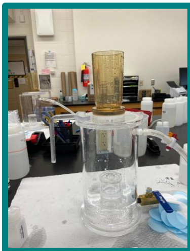
Figura 18. Sistema de filtración de las muestras de depósito atmosférico húmedo, NADP
