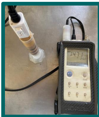
Figura 21. Potenciómetro de conductividad SCA-ICAYCC HORIBA D-24
