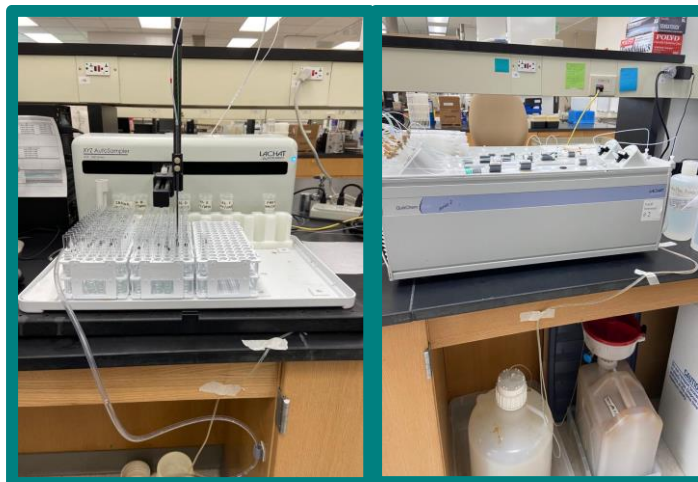
Figura 26. Equipo para determinación de amonio y ortofosfato. FIA (Flow Injection Analyzer) Lachat Instruments (Hach) QuickChem 8500 Series . NADP
