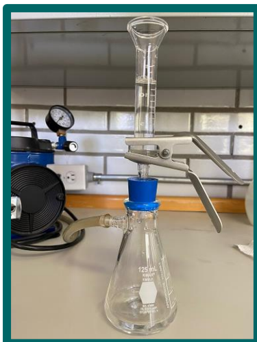
Figura 17. Sistema de filtración de las muestras de depósito atmosférico húmedo SCA-ICAYCC
