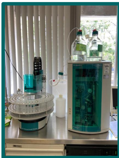
Figura 23. Cromatógrafo de líquidos SCA-ICAYCC, Metrohm 850 Professional IC
