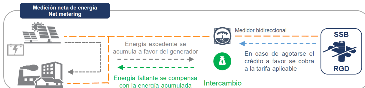
Ilustración 8 Medición neta de energía (“Net Metering”)
