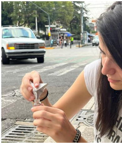
Figura 38. Vaciado de reactivo para medir concentración de cloro libre en muestra de agua.
