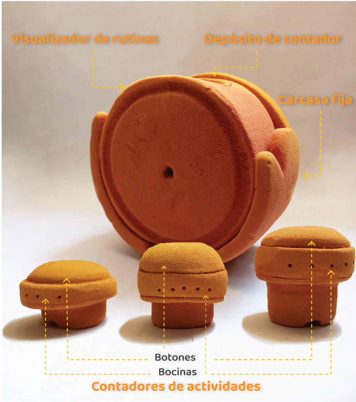
Figura 35. Modelo físico hecho en tallacel para la segunda prueba.
