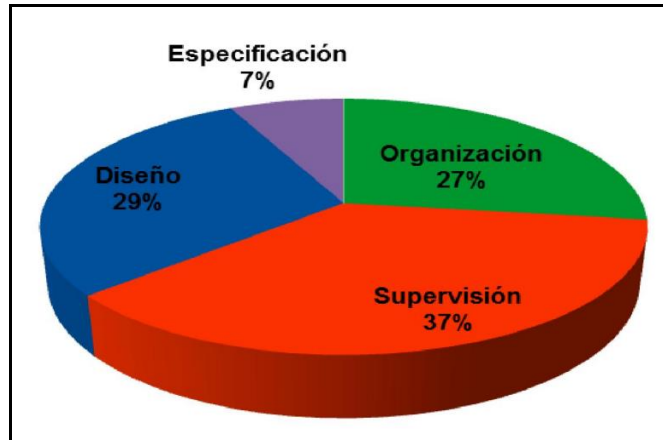
Gráfica 3 Distribución de frecuencias de incidencia de las causas de fallas en la etapa “Acabado exterior”, clasificadas por área. (Audeves Pérez et al., 2013)
