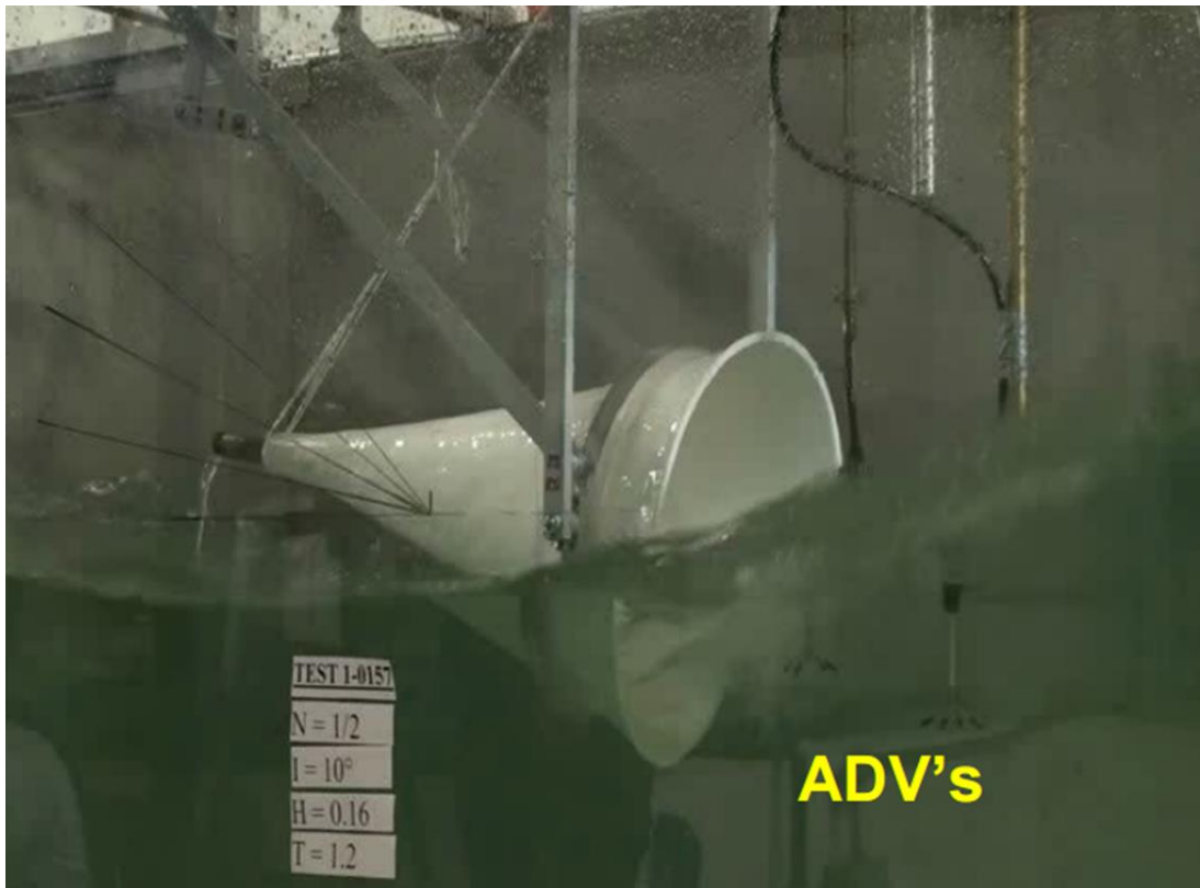
Fig. 15. Blow-Jet durante pruebas. Adaptado de Wave Energy Conversion Using a BLOW-JET System, Mendoza, et al, 2011 [41].
