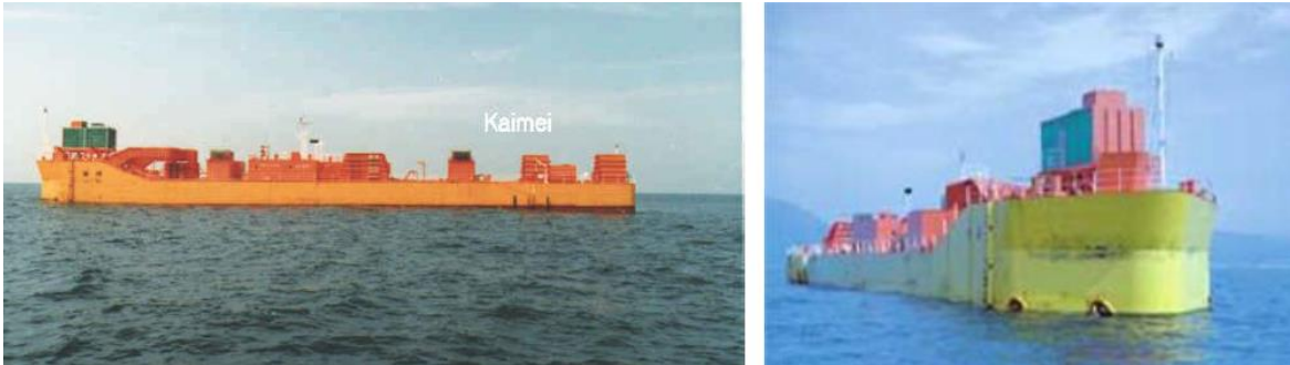
Fig. 11. Embarcación diseñada por Yoshio Masudo basada en OWC. Adaptado de Modelling of wave energy Conversion, Falcão, 2014 [33].
