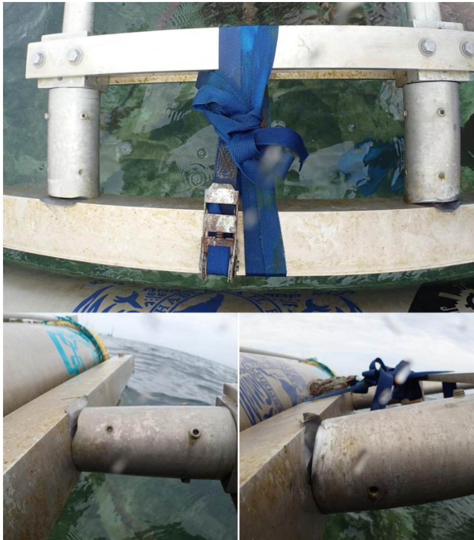
Fig. 42, Daños en la sujeción de la boya con el brazo.
