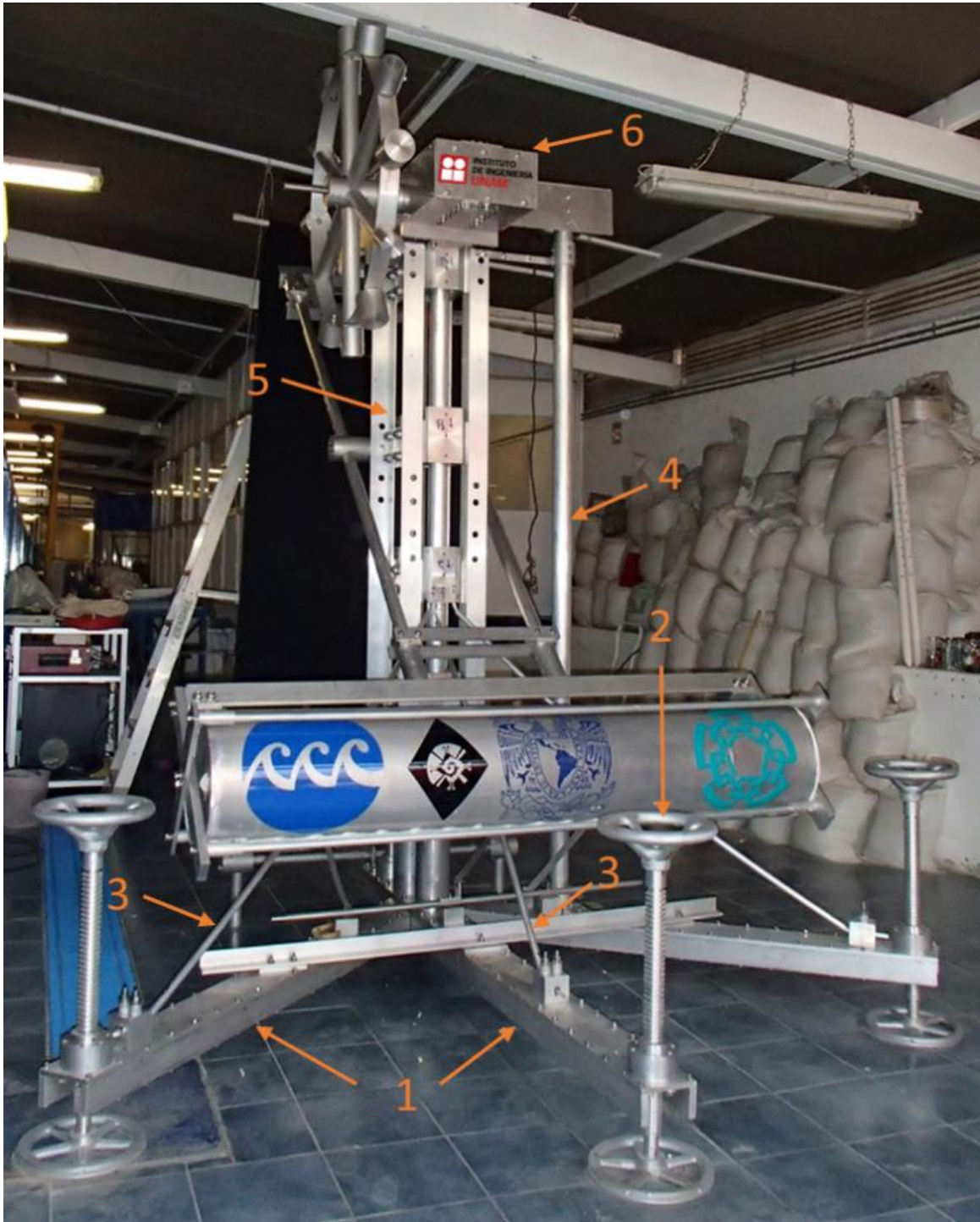
Fig. 27. MICO T1 con adaptaciones finales. 1 Base de solera, 2 Trepano para suelo arenoso, 3 Vigas de soporte, 4 Poste para base de chasis, 5 Ángulos de aluminio para colocación de instrumentación, 6 Chasis de generación de mayor tamaño.
