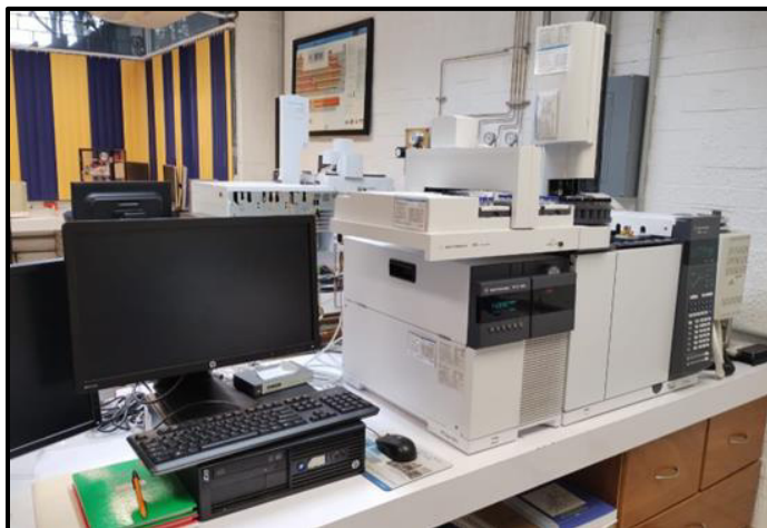
Fig. 2.2. Cromatógrafo de gases acoplado al espectrómetro de masas del LANCIC-IQ. Archivo personal del autor.
