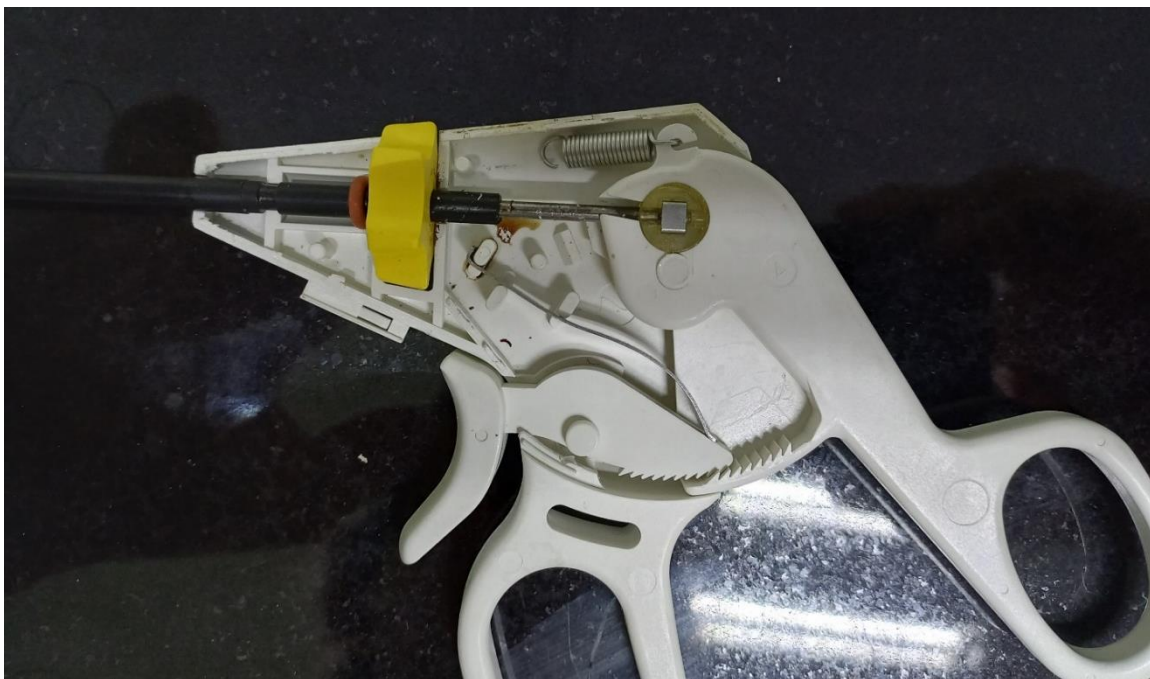
Figura 39 Mecanismo interno de pinza grasper marca Medtronic.
