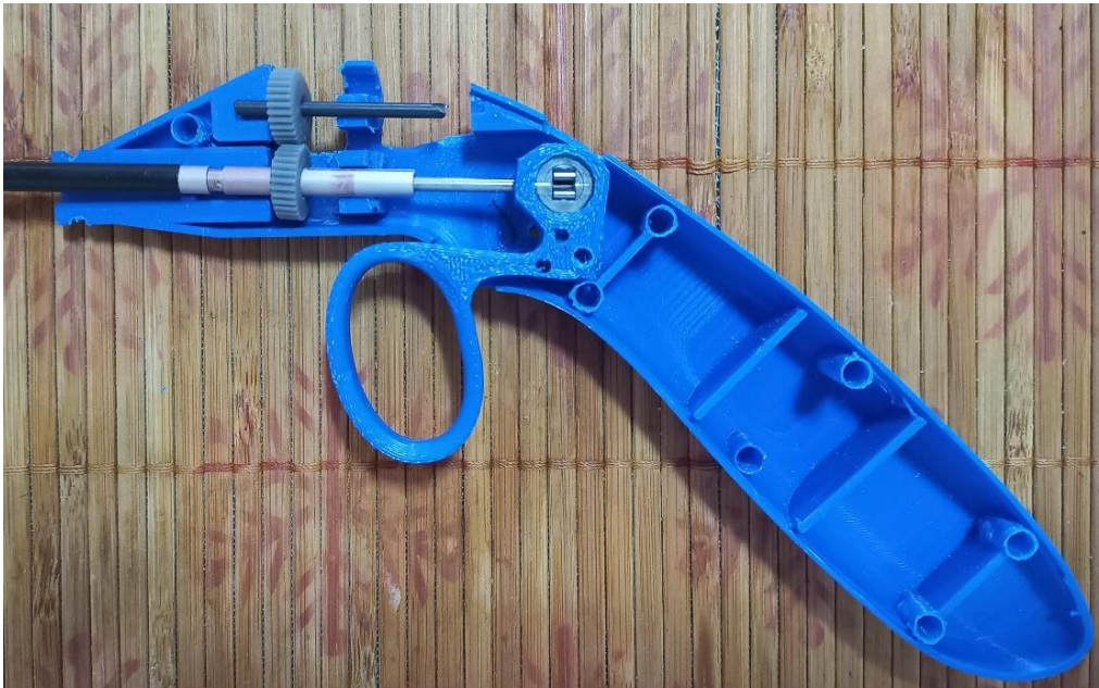
Figura 43 Mecanismos internos de prototipo N2.
