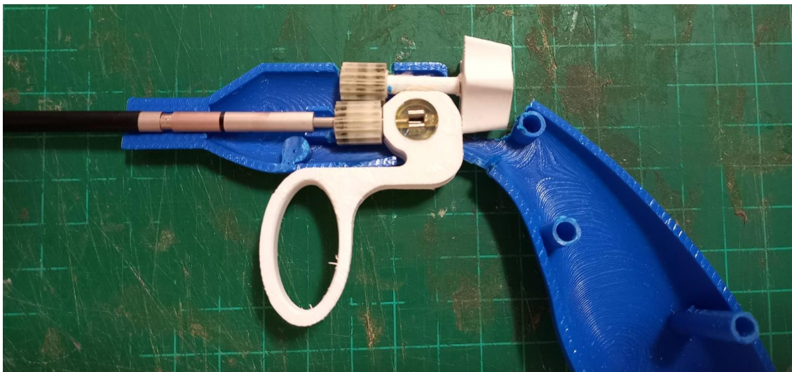
Figura 41 Mecanismos internos de prototipo N1.
