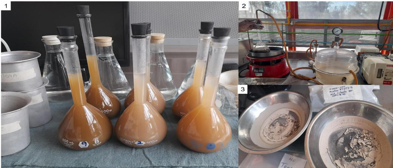
Figura IV.3. Análisis de densidad de sólidos por método de picnómetro.
