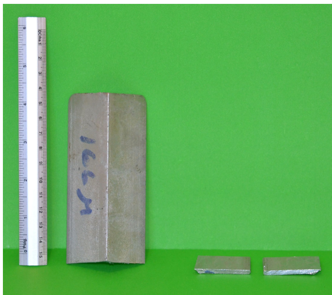
Figura 3.1: Placas de acero galvanizado en caliente proporcionadas por Galvaqro S.A. de S.V
