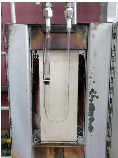
*Figura 27. Reactor en forma de U con catalizador sulfurado.*
