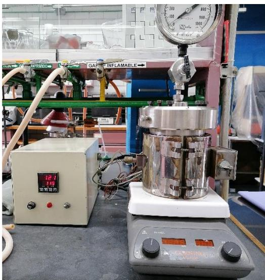
Figura 19. Autoclave montada durante la síntesis de los nanotubos de titanía
