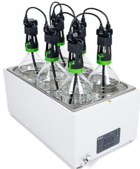
Figura 4.4: Frascos, agitadores y sistema de calentamiento para la metanización de la cáscara de cacao fermentada y sin fermentar.
