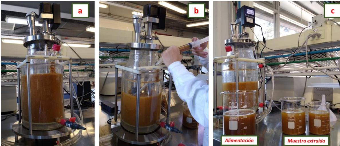
Figura 5.3: Fermentación de la cáscara de cacao: a) reactor operando en semicontinuo (3.8 L), b) método de extracción de muestra, y c) vista comparativa de la muestra extraída y la alimentación diaria
