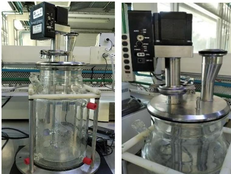
Figura 4.3: Dos vistas del reactor con chaqueta de temperatura para fermentación de las cáscaras de cacao trituradas.
