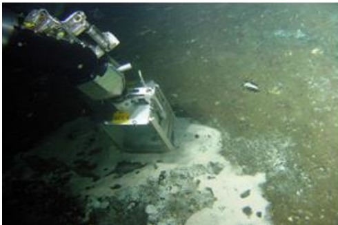
Figura 5. Hábitat tapete bacteriano. Colecta de sedimento superficial con el núcleo GCL 1. Imagen: IFREMER/BIG 2010.
