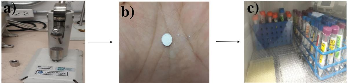
**Figura 4.9:** a) Prensa manual (Pellet Press), b) Patillas prensadas de fosfatos de calcio, c) Pastillas dentro de la incubadora con saliva artificial
