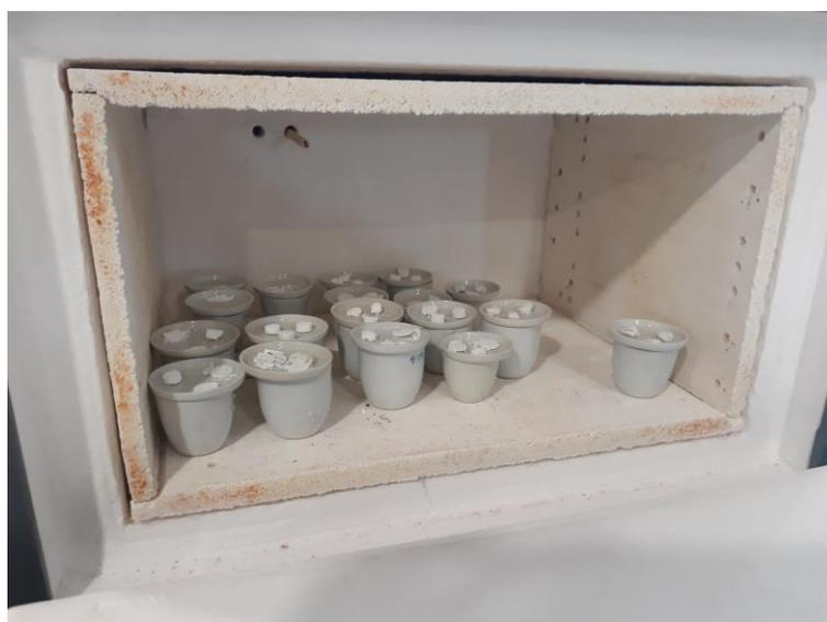
**Figura 4.11:** Andamios dentro de un horno para su secado.
