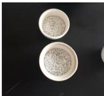
**Figura 4.6:** Óxido de calcio formado después del proceso de calentamiento.
