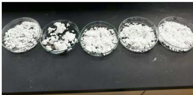
**Figura 4.7:** Polvos de fosfatos de calcio en cajas de Petri para completar la reacción química.
