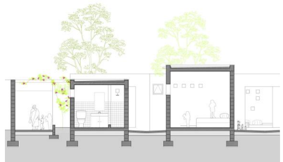
Imagen 55. Diferencia de alturas entre los baños y las habitaciones como forma de disipar el calor en los espacios con más gente. Fuente: ArchDaily. Urko Sanchez Architects
