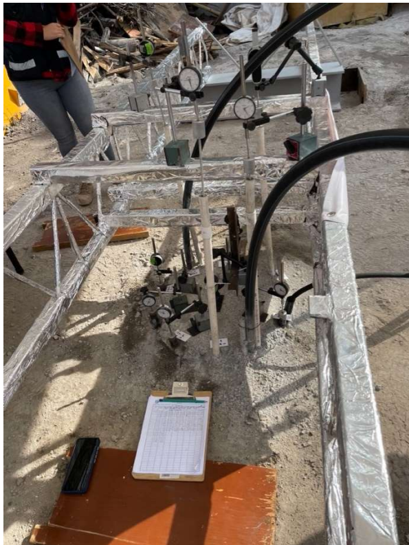
Figura D.7 Mangueras para ensaye tipo TRT, en la cabeza de la pila.
