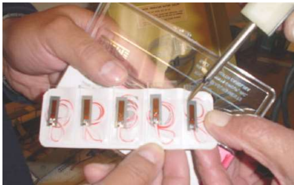
Figura 2.11 Deformímetros soldados al acero de refuerzo, Paniagua et al. (2008).
