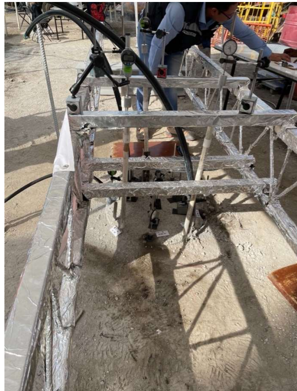
Figura D.7 Mangueras para ensaye tipo TRT, en la cabeza de la pila.
