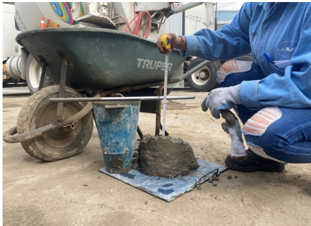
Figura C.12 Prueba de revenimiento y toma de especímenes para ensaye del concreto.
