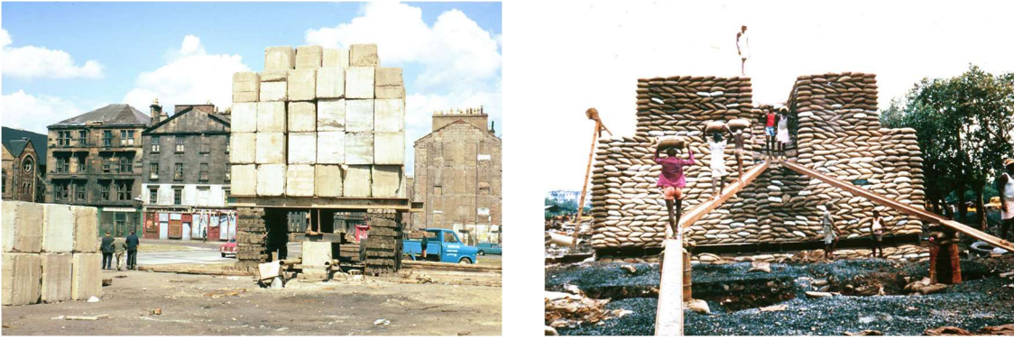
Figura 2.4 Sistemas de reacción con lastre, Fellenius (2005).
