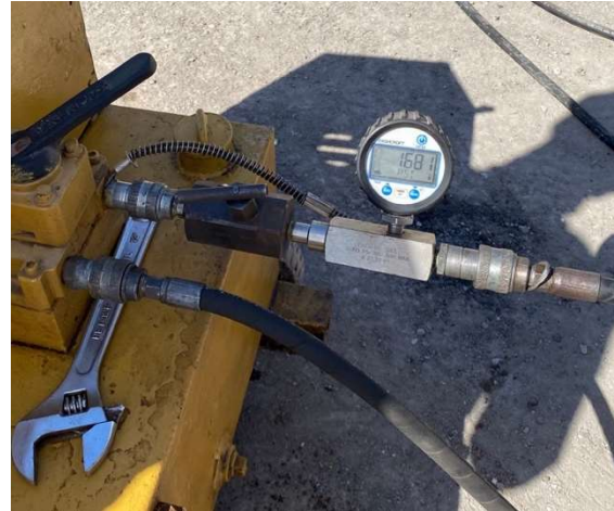
Figura 6.5 Bomba para aplicación de presión y manómetro digital.
