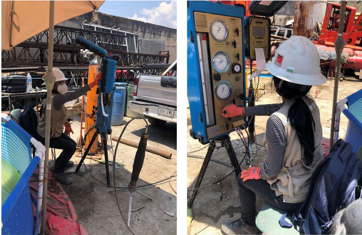
Figura B.4 Ejecución de ensayos de presiómetro Ménard.
