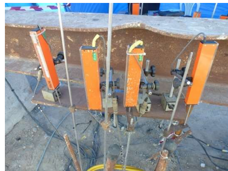
Figura 3.17 Instrumentos electrónicos (LVDT) para medición de deformaciones en barras testigo ( tell tales ) y en la cabeza de la pila (cortesía R Rivera).
