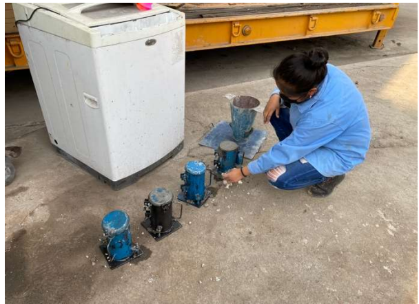
Figura C.12 Prueba de revenimiento y toma de especímenes para ensaye del concreto.
