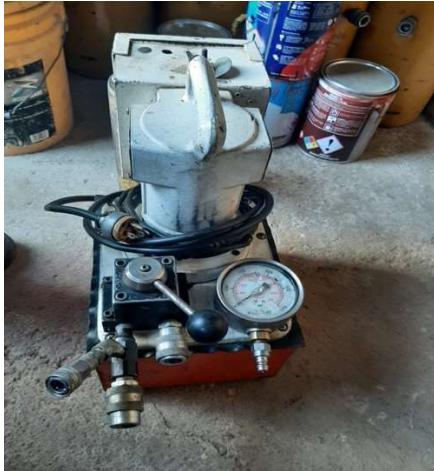
Figura 6.5 Bomba para aplicación de presión y manómetro digital.
