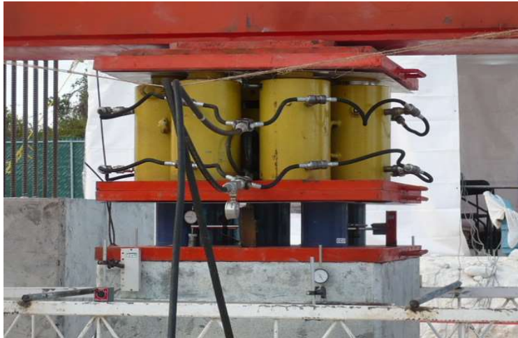
Figura 2.8 Gatos hidráulicos para la aplicación de la carga en la cabeza (en amarillo), celdas de carga (en azul) y manómetro para medir la presión en el sistema hidráulico.
