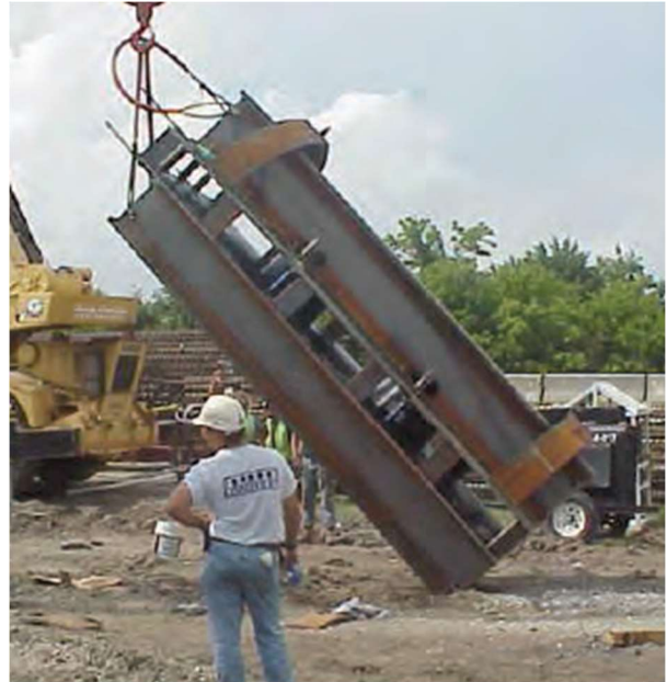
Figura 3.29 Celda bidireccional para prueba lateral, O'Neill et al. (1997).
