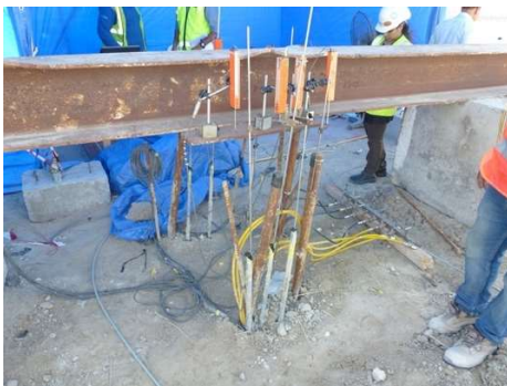
Figura 3.17 Instrumentos electrónicos (LVDT) para medición de deformaciones en barras testigo ( tell tales ) y en la cabeza de la pila (cortesía R Rivera).
