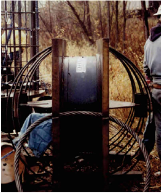
Figura 3.29 Celda bidireccional para prueba lateral, O'Neill et al. (1997).
