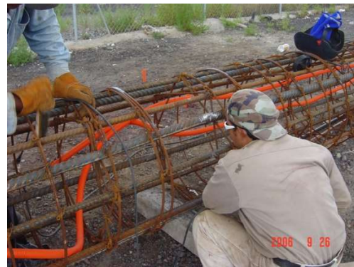
Figura 2.11 Deformímetros soldados al acero de refuerzo, Paniagua et al. (2008).
