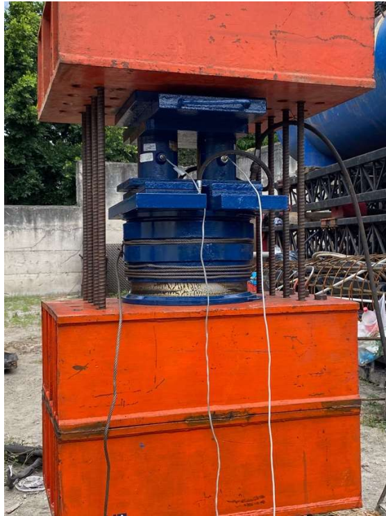
Figura D.4 Marco de calibración de celda bidireccional.
