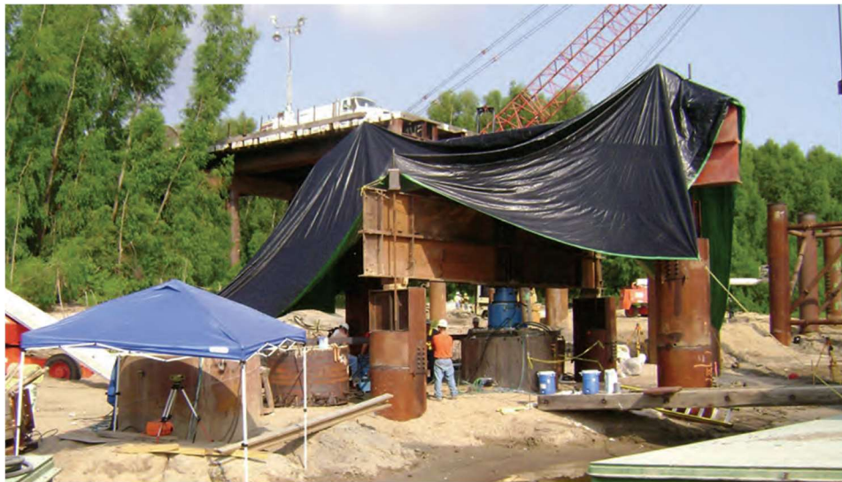
Figura 3.9 Prueba de carga bidireccional más sistema de reacción, Brown et al. (2010).
