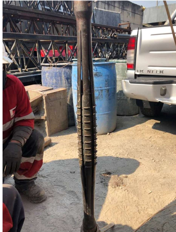
Figura B.2 Sonda de ficómetro utilizada. Diagrama a la izquierda, Santoyo (2010).
