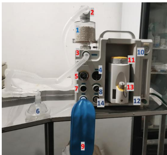
Figura 3: Partes de Maquina de anestesia. (1. Absorbedores, 2. Salida de inspiración, 3. Salida de expiración, 4. Manómetro, 5. Válvula APL, 6. Mascarilla, 7. Pulsador de descarga de O 2 , 8. Interruptor CGO/CGO, 9. Bolsa, 10. Manómetro de regulación de O 2 , 11. Panel de concentración, 12. Regulación de caudal de O 2 , 13. Perilla de adición de anestésico, 14. ACGO)
