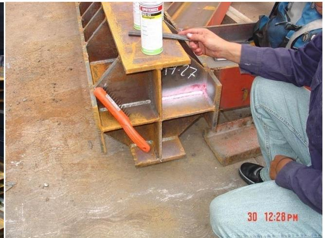
Se visitó el taller donde se solda las vigas jois a base de vigas "I" y placas para los ensambles; se realizaron radiografías a la soldadura se contrató a un laboratorio para estas pruebas.
