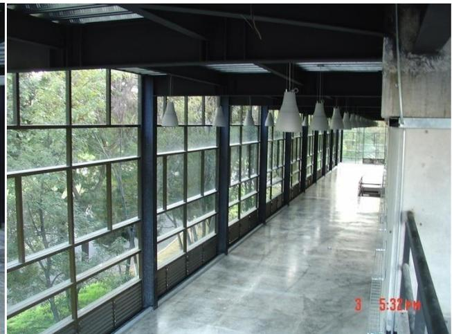
**Tercer nivel y cuarto nivel, a doble altura con reflectores para la zona de lectura, piso pulido y muro aparente y cancelería de aluminio duranodick y cristal de 9 mm.**
