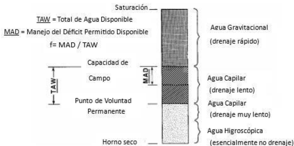
Figura 1. Representación esquemática de la capacidad de campo y el punto de marchitez permanente del contenido de humedad del suelo.
