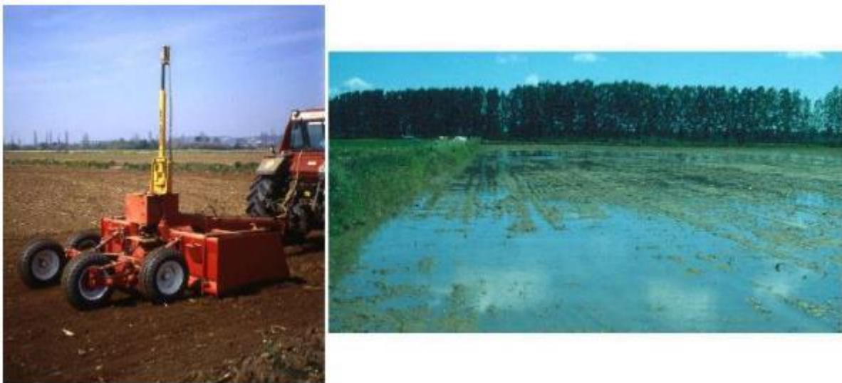
Figura 12. Equipo de nivelación por láser y parcela nivelada con este equipo
