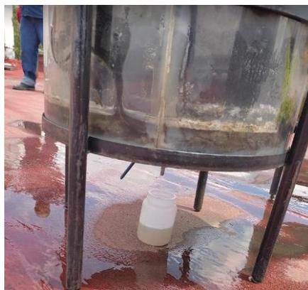
**Figura 5.27. Recolección de los lixiviados en el lisímetro 2, (elaboración propia, 2022)**
