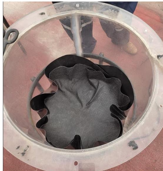
b. Colocación de la geomalla y el geotextil
