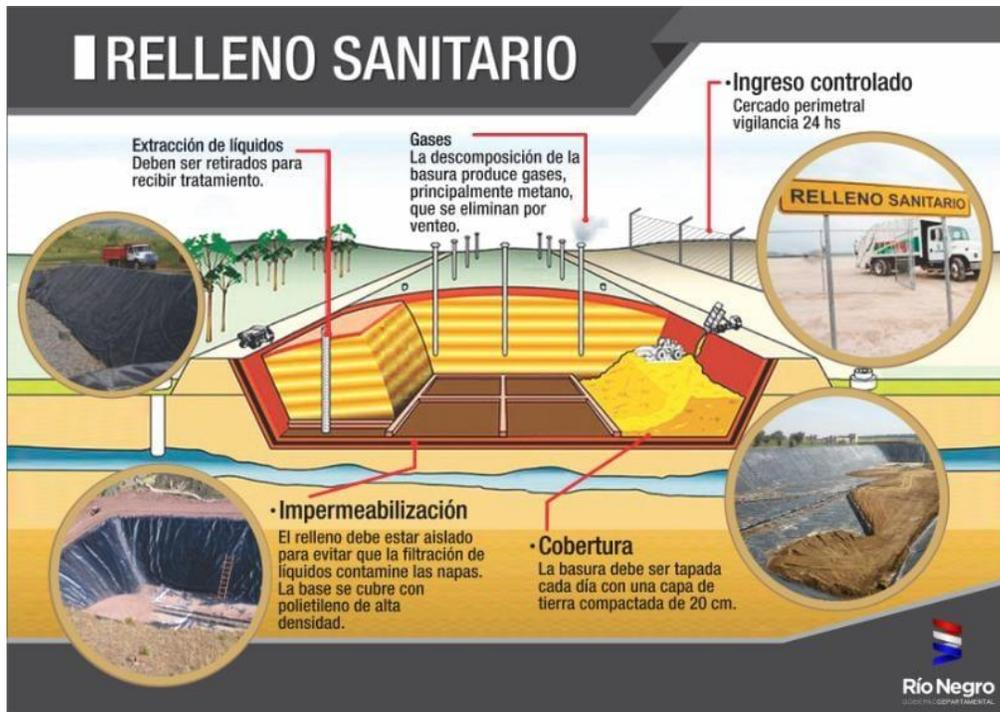
**Figura 4.8. Conformación típica de un relleno sanitario (fuente: Río Negro, 2022)**
