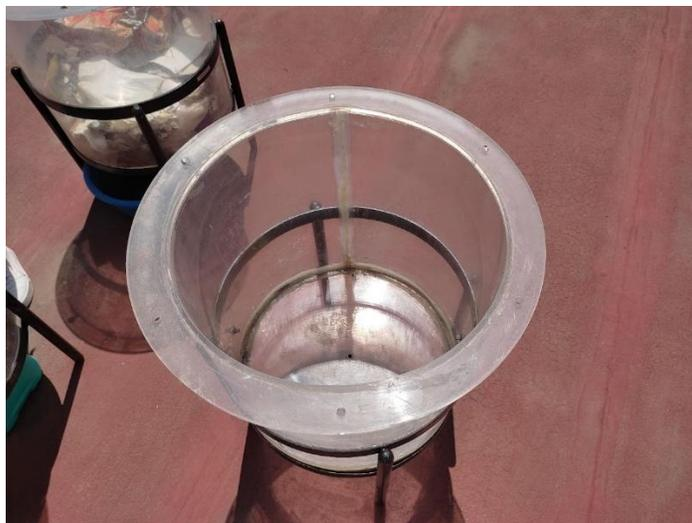
**Figura 4.2. Ejemplo de los lisímetros que serán utilizados para el desarrollo experimental (elaboración propia, 2022)**
