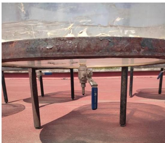
**Figura 4.3. Válvula inferior para el drenado de lixiviados (elaboración propia, 2022)**
