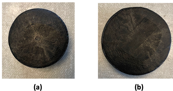
Figura 3.5: Bultos YBCO proporcionados por GREEN. (a) 31 mm de diámetro 16.84 mm espesor (b) 47.1mm de diámetro y 17.8 mm espesor.
