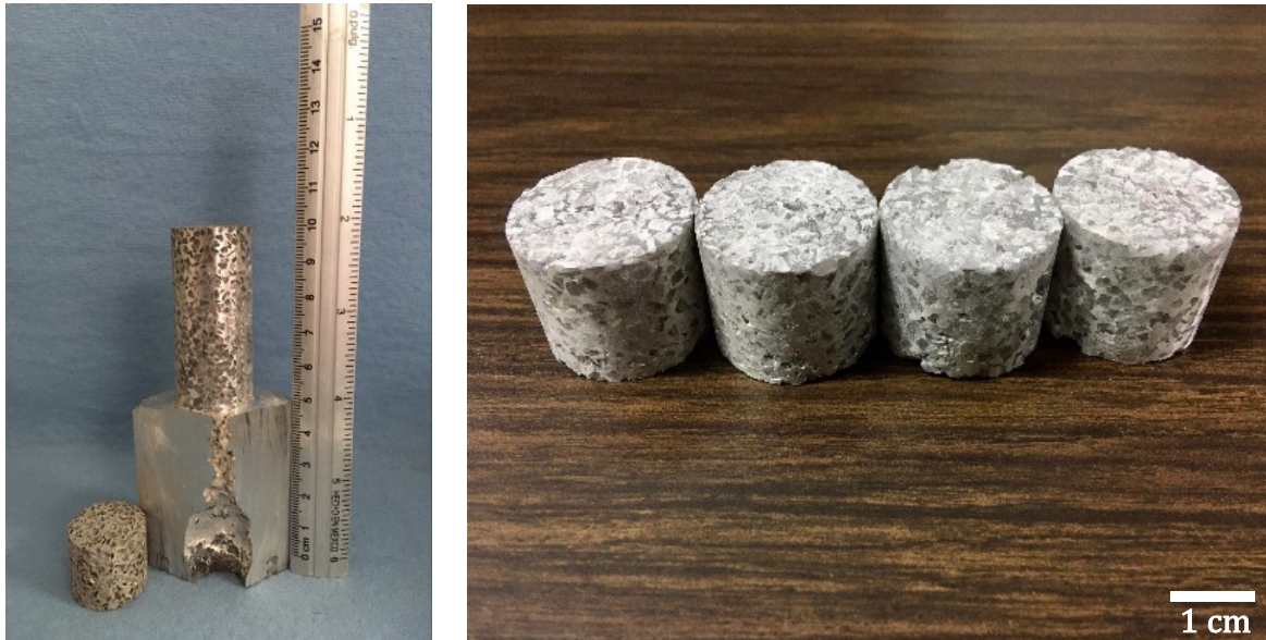
(a) (b) Figura 39. Corte de las espumas, (a) Después del maquinado y (b) Material compuesto de NaCl+Mg(Li).
