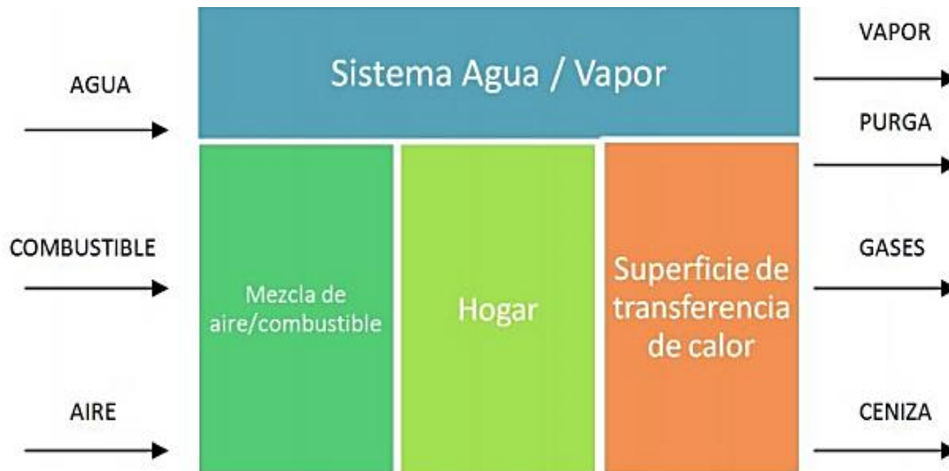
Figura 8. Funcionamiento de una caldera (Martínez, J. 2013).
