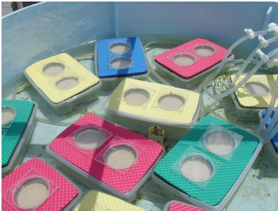
Figura 5. Montaje experimental para determinar el efecto de la UVR sobre asentamiento de larvas de Acropora palmata y Orbicella faveolata en 2011.
