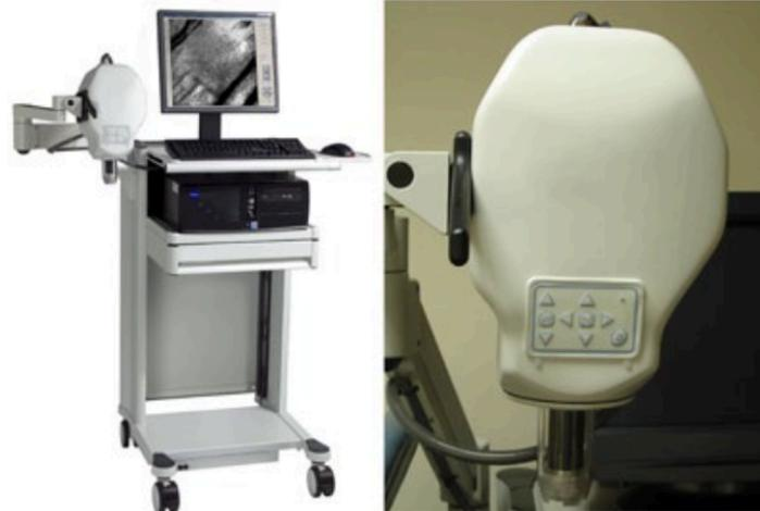
**Figura 3.** Equipo de microscopio confocal de reflectancia de última generación Vivascope 3000®.
