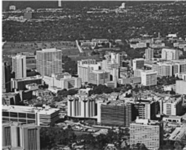
Fig 2.3 Ejemplo de rugosidad de terreno tipo B. Nota. Adaptado de “Minimum Design Loads for Buildings and other Structures” (p. 876) por American Society of Civil Engineers, 2021.
