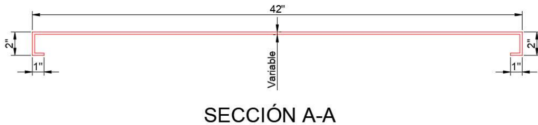
Fig 3.7 Dimensiones de panel de aluminio - Sección
