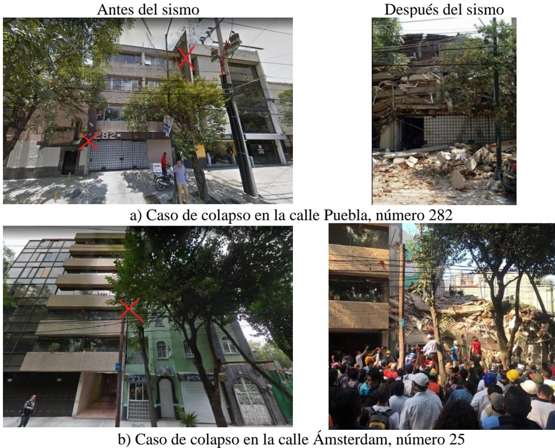
**Figura 2.6** Edificios en la zona de estudio con daño total donde se identificó golpeteo, (Reinoso *et al.*, 2019)
