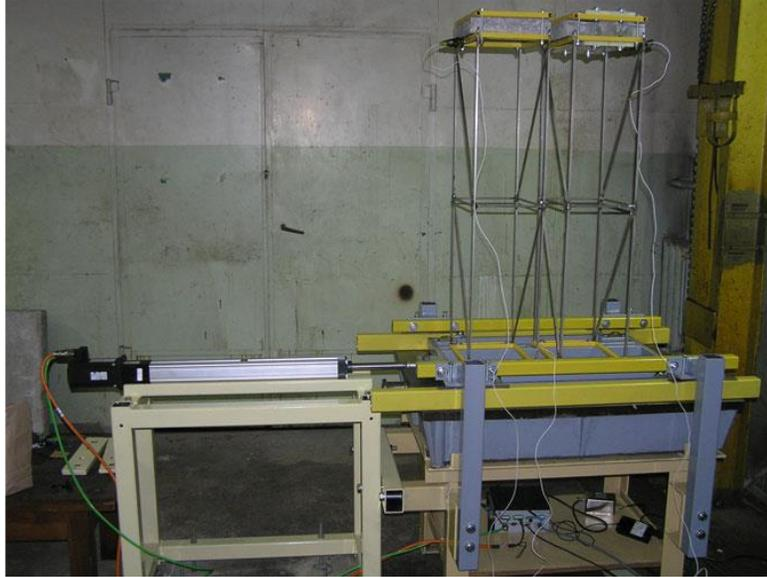
**Figura 1.4** Configuración del experimento en mesa vibratoria (Jankowski y Mahmoud, 2015)
